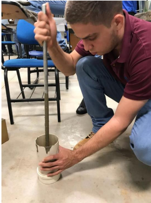
Figura 28 - Exemplo de adensamento do concreto no corpo de prova
