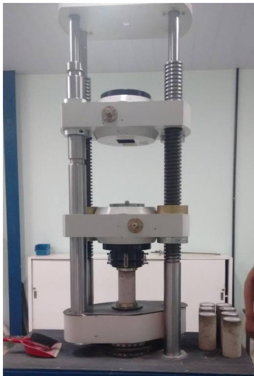
Figura 11 – Ensaio de resistência a compressão dos corpos de prova
