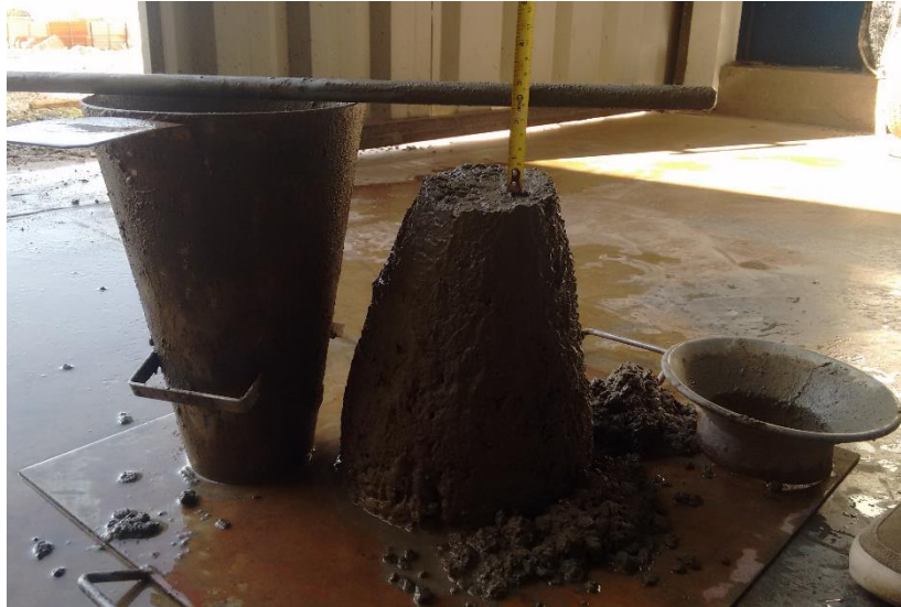
Figura 8 – Ensaio de abatimento (Slump test)
