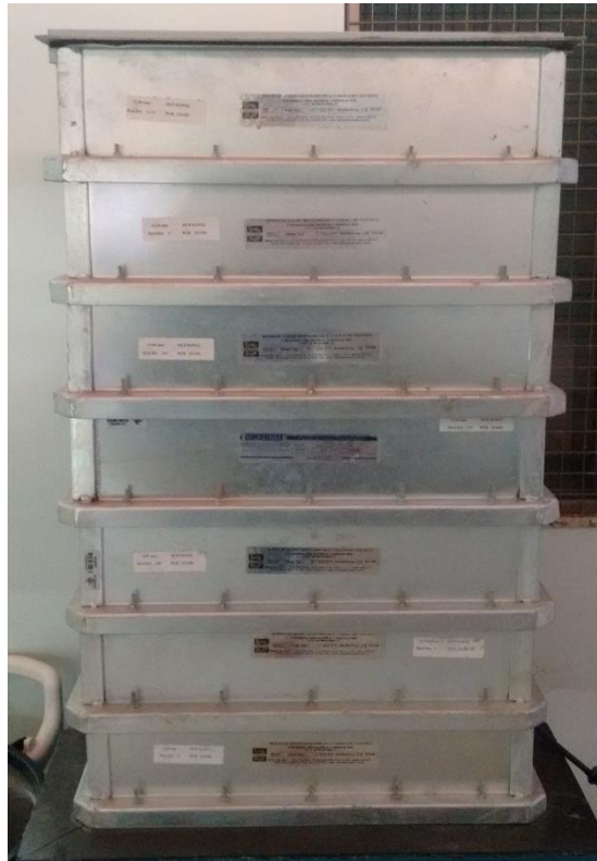
Figura 6 - Peneiras utilizadas no ensaio de granulometria da brita
