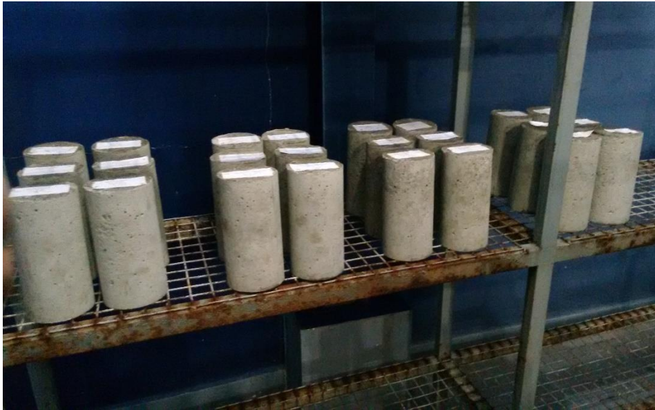
Figura 10 – Cura do concreto câmara úmida
