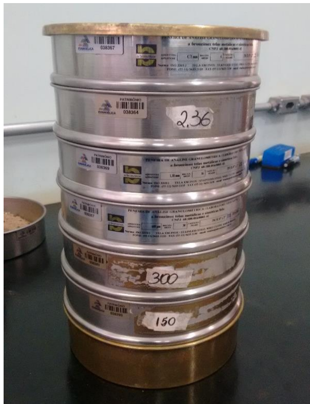
Figura 5 - Peneiras utilizadas no ensaio de granulometria da areia
