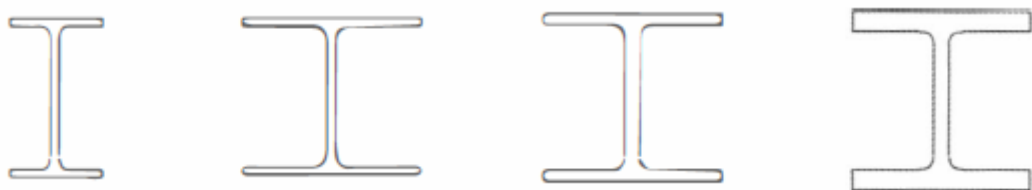
Figura 2 - Perfis laminados de abas com faces paralelas de padrão europeu
