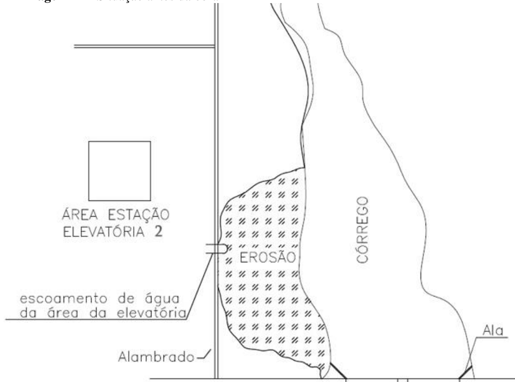
Imagem 24 - Situação antes da obra
