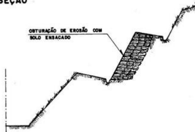
Imagem 6 - Muro de sacos de solo-cimento SEÇÃO
