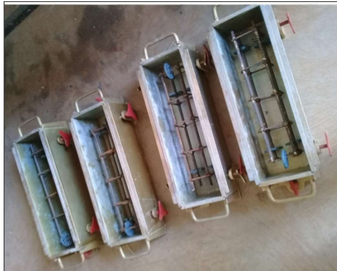
Figura 36 - Forma das peças de concreto armado
