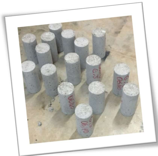
Figura 37 – Corpos de prova para ensaio à compressão axial
