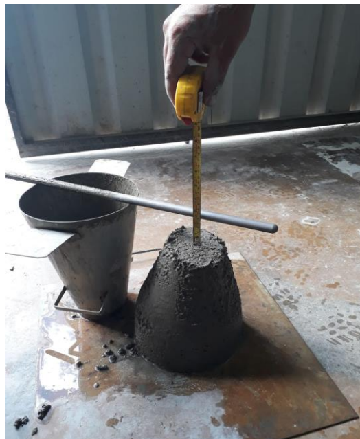
Figura 8 - Abatimento do concreto medido pela diferença entre a altura do molde e a altura do eixo do corpo de prova desmoldado.
