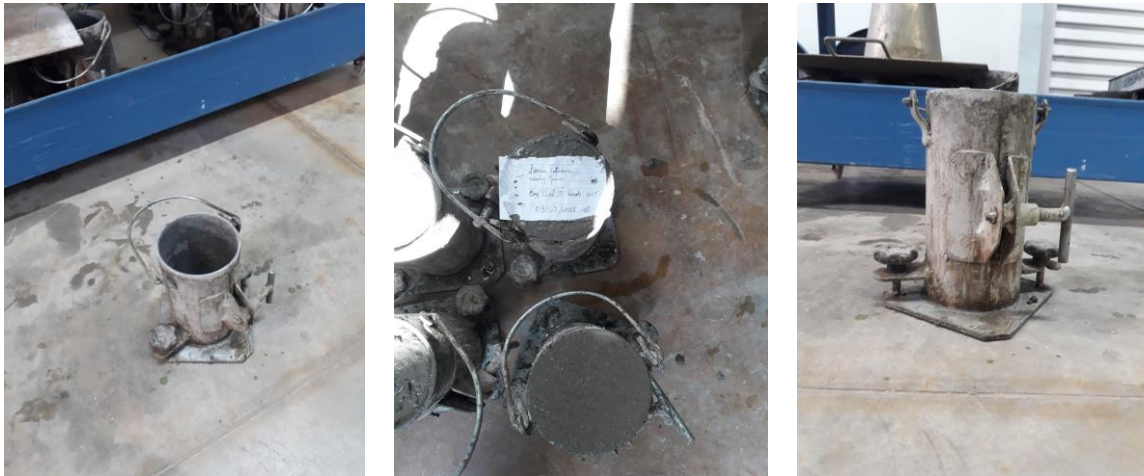
Figura 9 – Corpos de provas cilíndricos nivelados.
