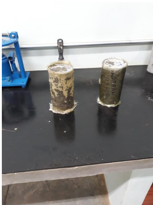
Figura 11 - Finalização do corpo de prova cilíndrico.
