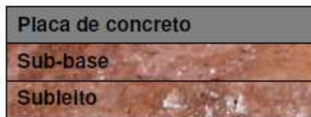
Figura 2 – Esquema de estrutura de um pavimento rígido
