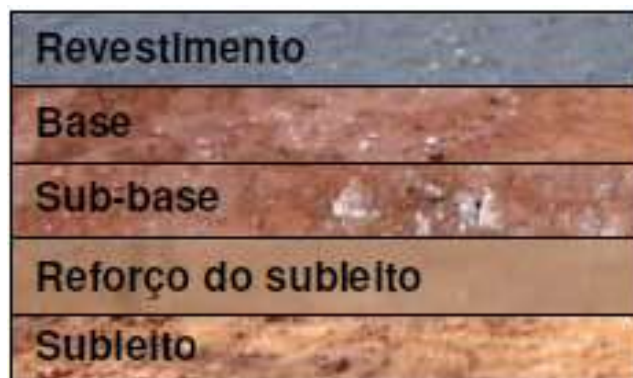
Figura 1– Esquema de estrutura de um pavimento flexível
