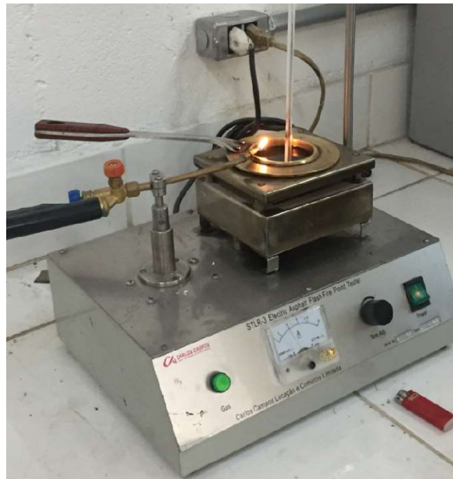
Figura 21– Aparelho para determinação do ponto de fulgor e combustão e vaso Cleveland
