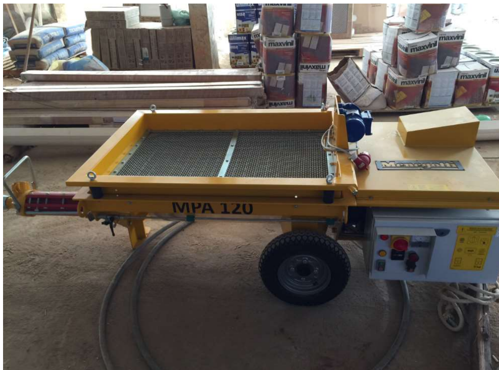
Figura 16 – Máquina projetora de argamassa usada no estudo
