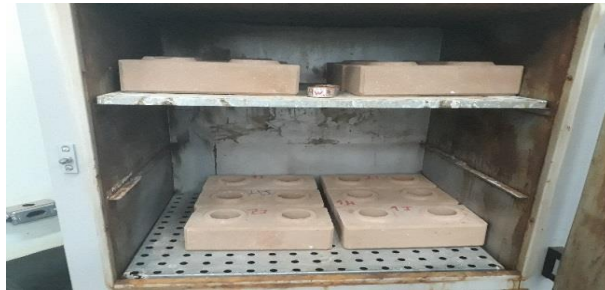
Figura 28 – Ensaio da absorção de água – CP na estufa
