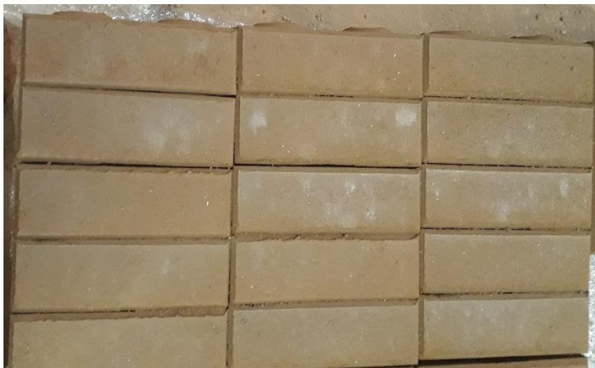
Figura 17 - Tijolo solo-cimento acabado
