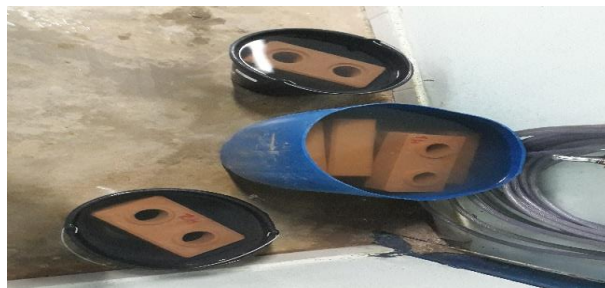
Figura 29 - Submersão dos corpos de prova
