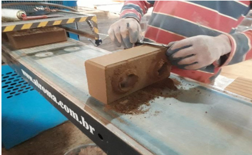
Figura 16 - Tijolo solo-cimento saindo da prensa
