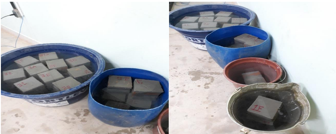
Figura 25 - Imersão dos corpos de prova
