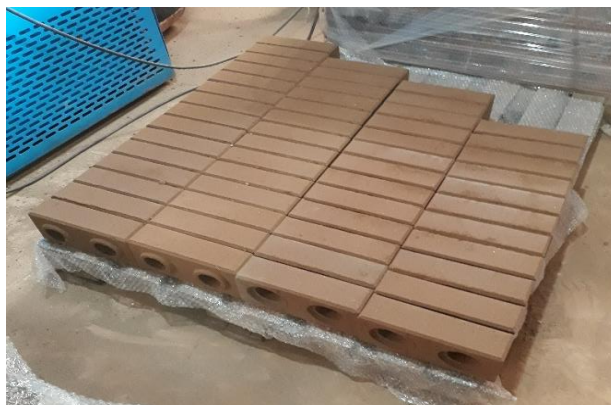
Figura 19 - Cura dos tijolos
