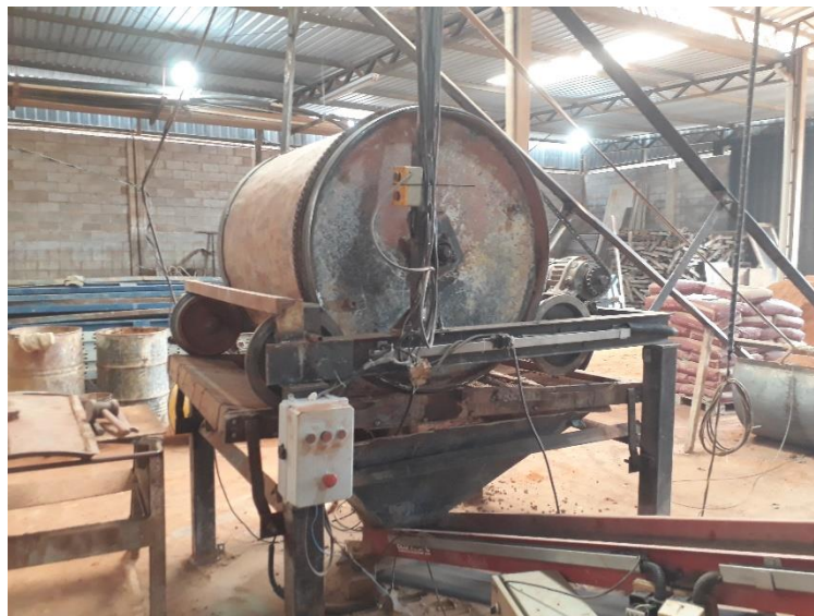
Figura 9 - Misturador automático e esteira transportadora
