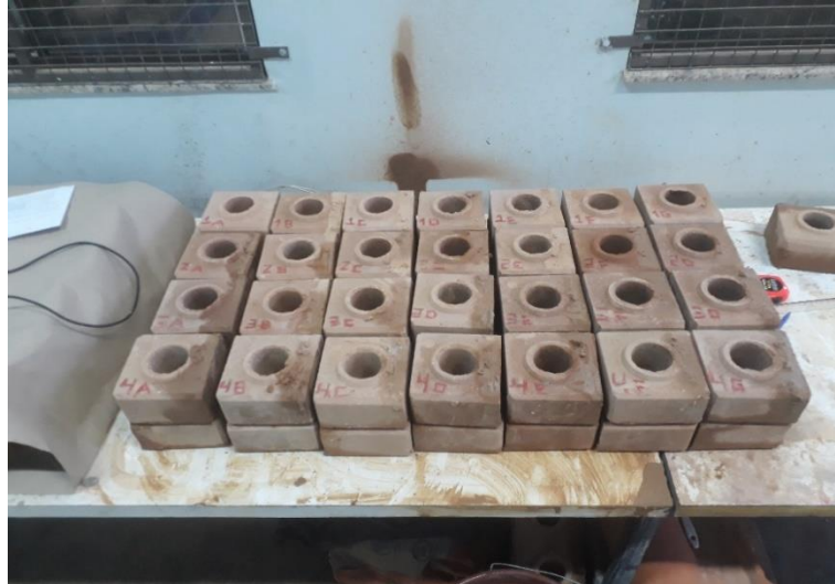
Figura 22 - Ensaio faces sobrepostas
