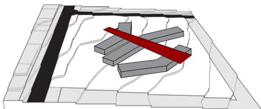
Para manter a individualidade dos blocos houve a necessidade de criar um elemento de ligação. Este elemento que também funciona de forma independente é uma cobertura que leva o usuário da entrada do edifício até o último bloco, passando por cada bloco e cada área externa, sendo o principal elemento de circulação.
