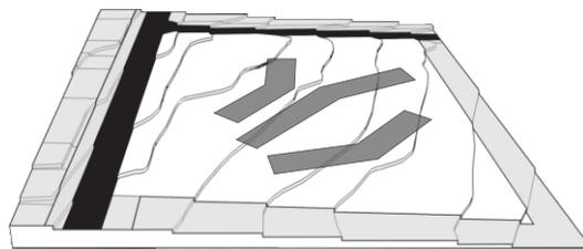
A partir da topografia, os blocos foram dispostos em níveis diferentes adequando os volumes ao sítio inserido. Os blocos foram posicionados de uma forma que equilibra as inclinações naturais do terreno eliminando a possibilidade de escadas e rampas dentro do edifício.
