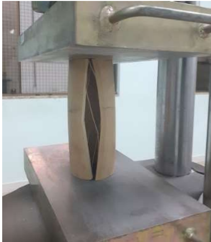
Figura 14 - Bambu sendo rompido no ensaio de compressão
