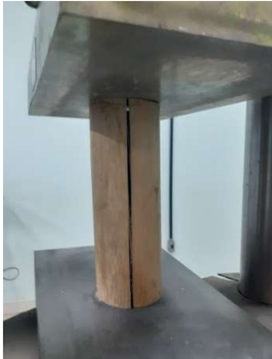
Figura 15 - Bambu de volta a posição inicial no ensaio de compressão
