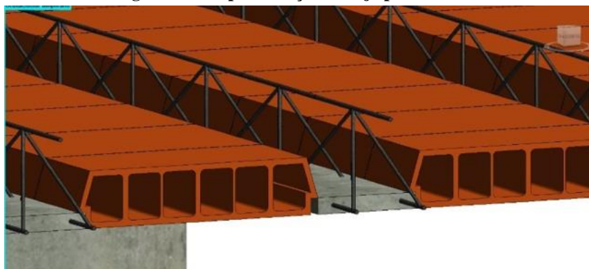
Figura 18 - Representação da laje pré-moldada
