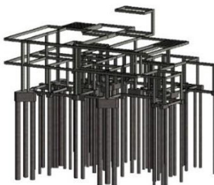
Figura 16 - Representação da estrutura completa em concreto armado
