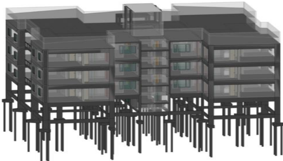
FIGURA 36 – Compatibilização entre projetos arquitetônico e estrutural
