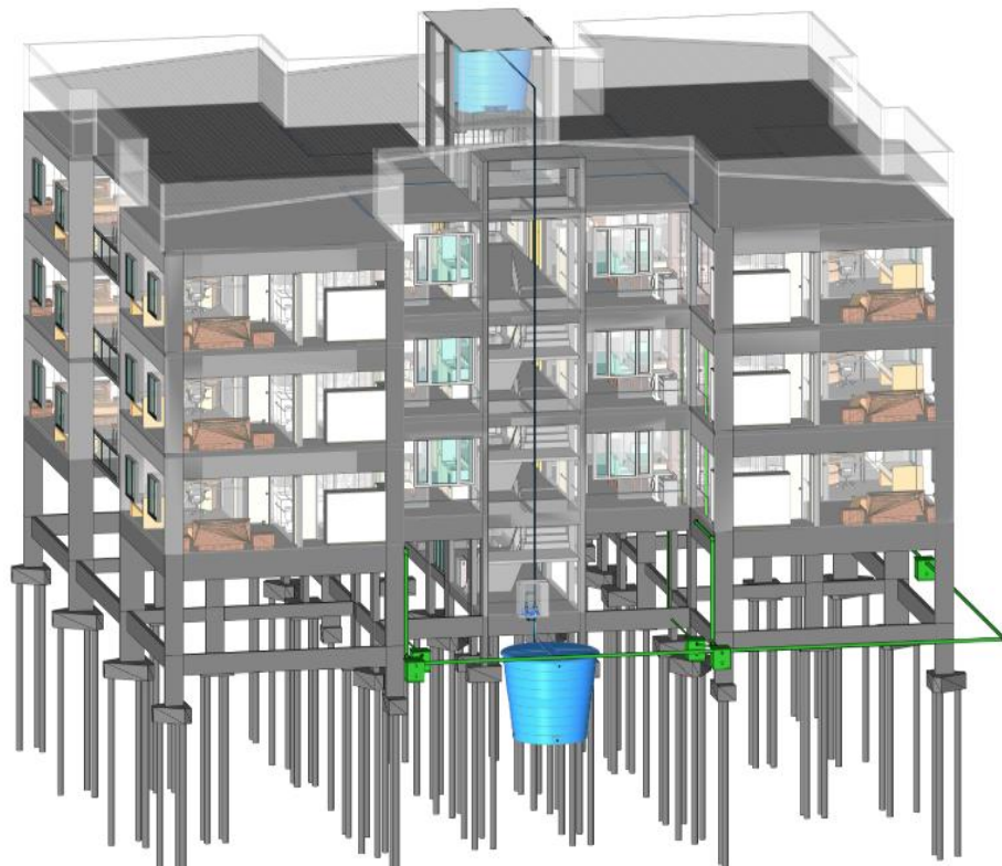
FIGURA 42 – Compatibilização de todos os projetos em BIM
