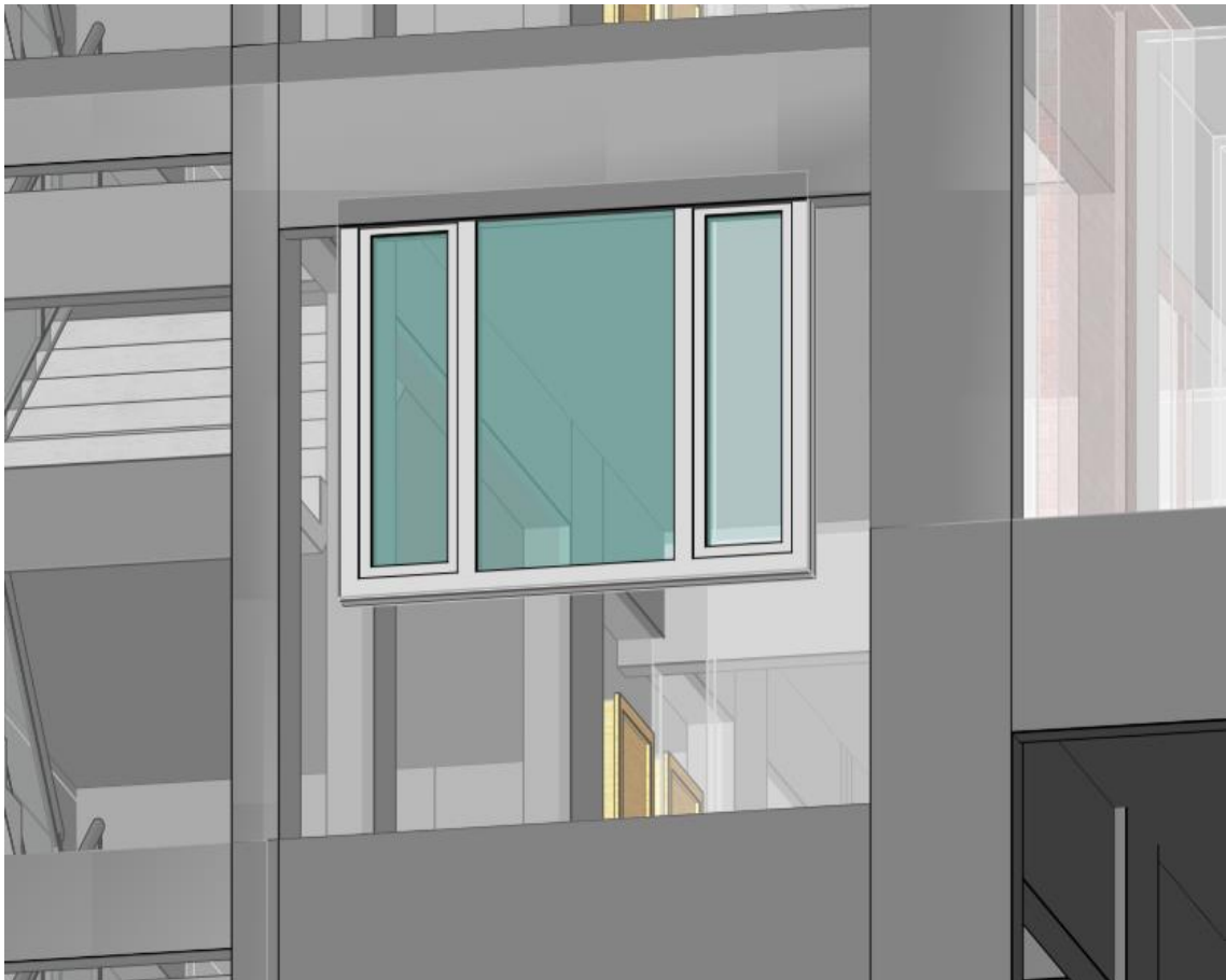
FIGURA 37 – Interferência entre janela e viga
