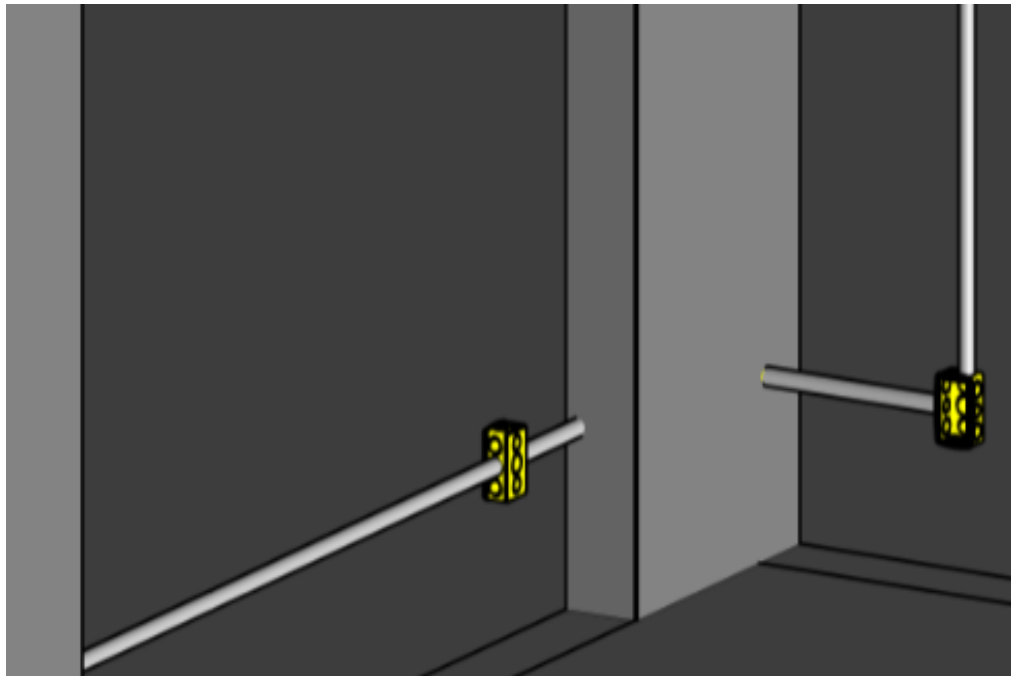
FIGURA 38 – Conduíte corrugado atravessando o pilar
