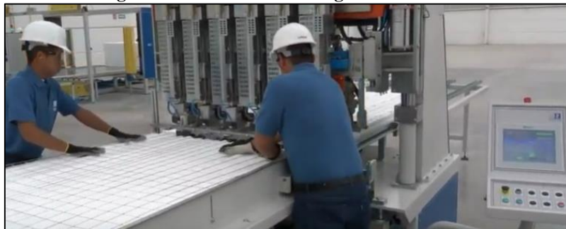
Figura 24 - Processo de soldagem entre as telas
