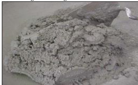
Figura 10 - Argamassa de cimento
