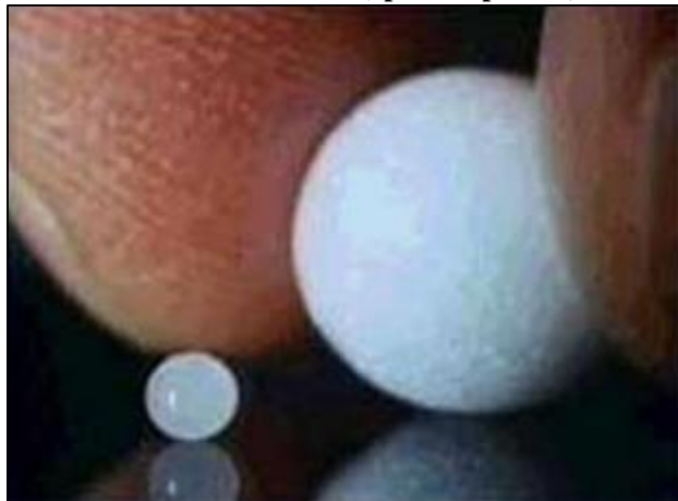
Figura 17 - Pérola de poliestireno (antes da expansão) e Granulado de EPS (após a expansão)
