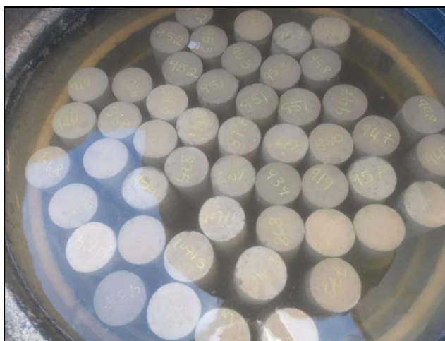
Figura 10 – Corpos de provas submersos para futuro rompimento.
