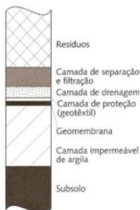
Figura 8 – Configuração de uma camada de proteção de fundo
