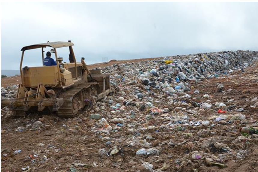
Figura 19 – Trator de esteira operando em um aterro
