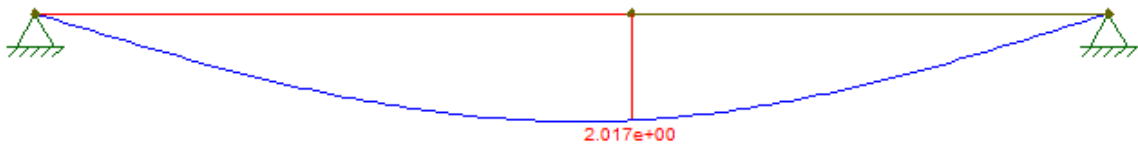
Figura 10 – Deslocamento real da viga posição 11
