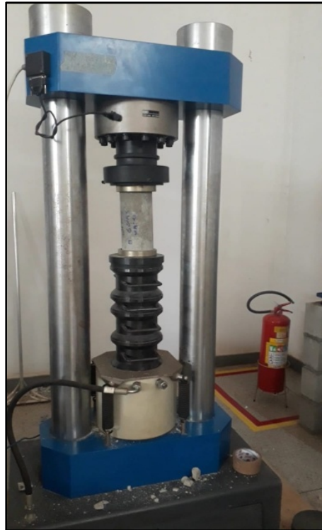
Figura 24: Prensa rompendo um dos corpos de prova com agregado graúdo da Pedreira A
