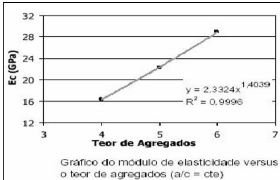
Figura 16 - Influência da quantidade de agregado sobre o módulo de elasticidade do concreto com relação água-cimento constante
