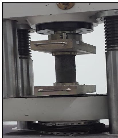
Figura 22: Prensa rompendo um dos corpos de prova com agregado graúdo da Pedreira B
