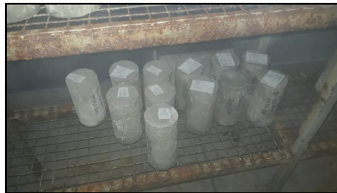
Figura 21: Corpos de prova na fase de cura na câmara úmida
