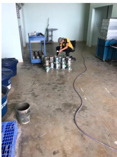
FIGURA 26 – Lubrificação dos moldes
