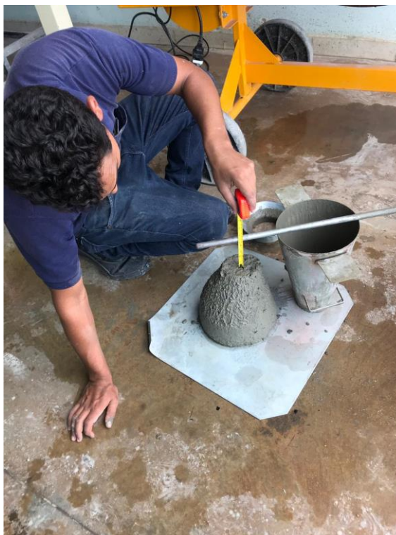
FIGURA 25 – Abatimento Tronco de Cone
