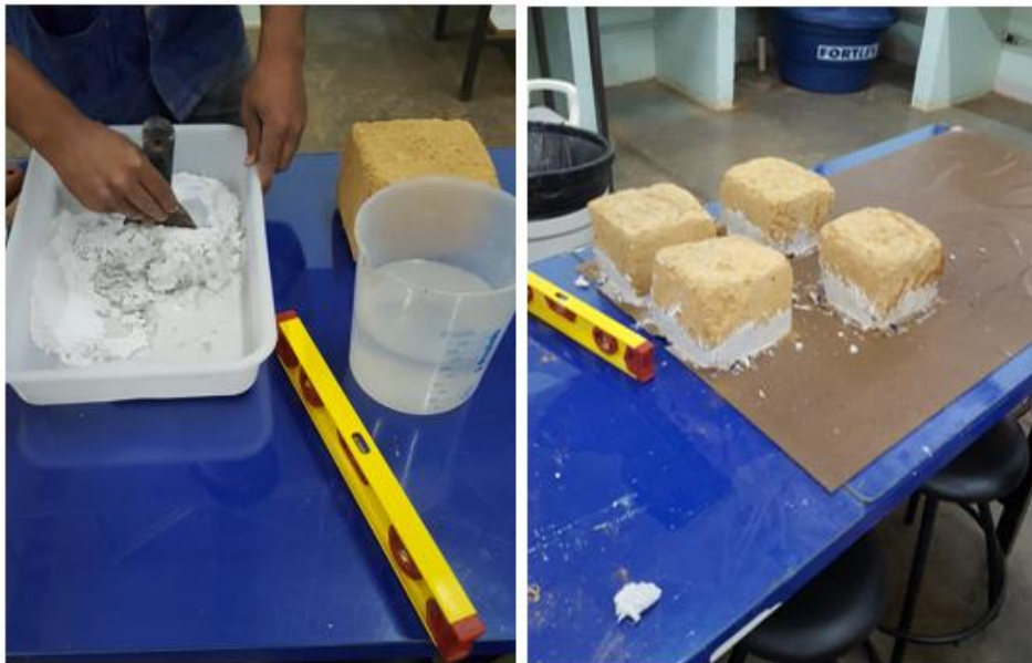
Figura 14 - Preparação da amostra para o ensaio.
