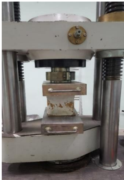
Figura 15 - Amostra na máquina universal de ensaios.
