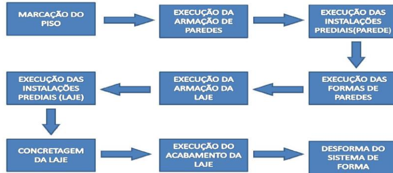
Figura 3 - Procedimentos de execução das paredes de concreto
