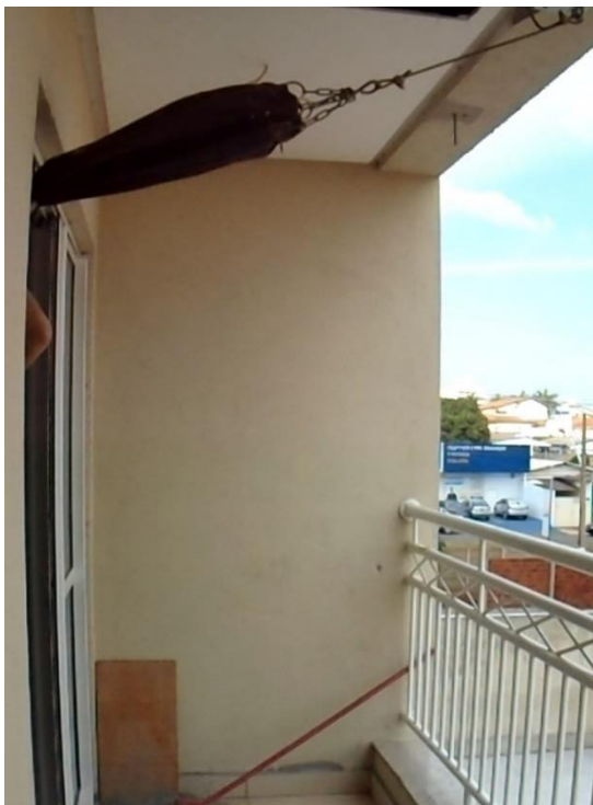
Figura 25 – Corpo mole suspenso a uma altura de 1,5 metros
