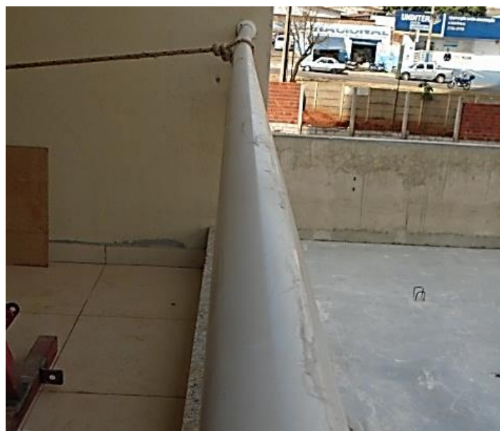
Figura 21 – Deformação horizontal visual do protótipo.
