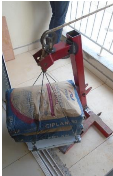
Figura 20 – Carga de uso no ensaio do esforço estático horizontal
