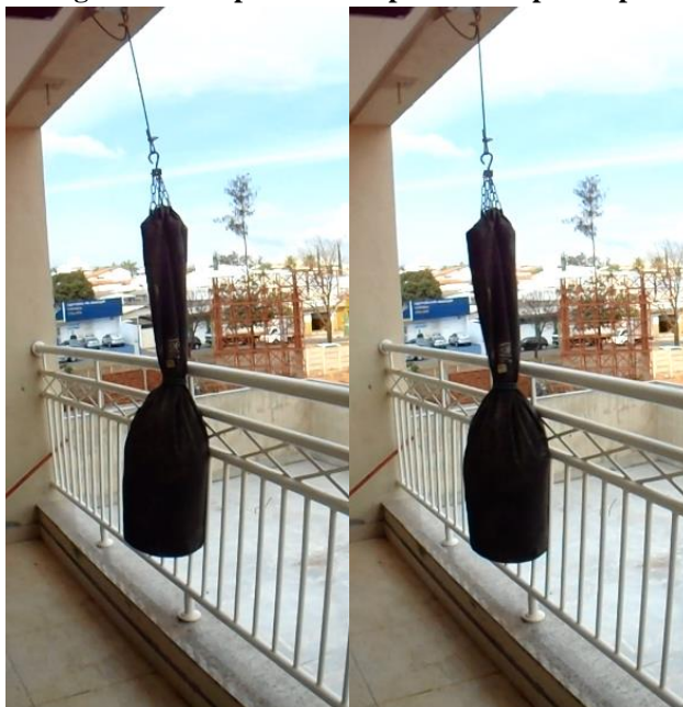
Figura 26 – Impacto do corpo mole no protótipo
