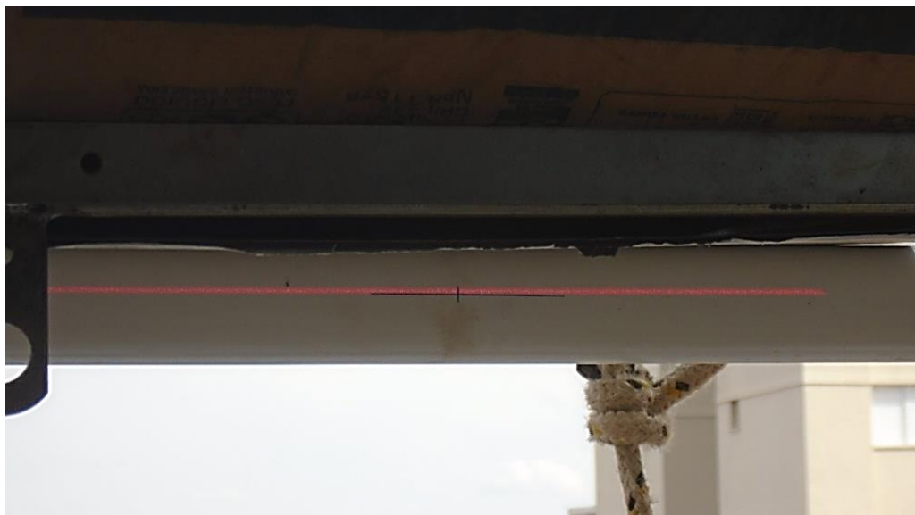
Figura 23 – Deformação vertical visual do protótipo.
