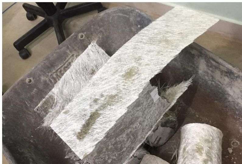
Figura 24 - Corpo de prova prismático rompido
