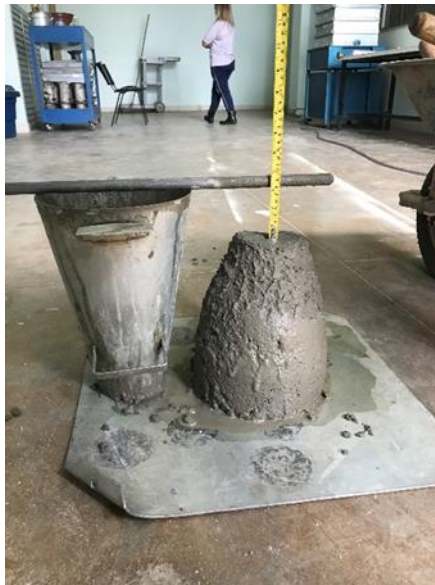
Figura 15 - Abatimento do concreto
