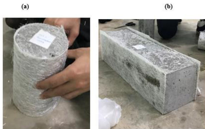
Figura 19 - Finalização dos corpos de prova (a) cilíndricos e (b) prismáticos
