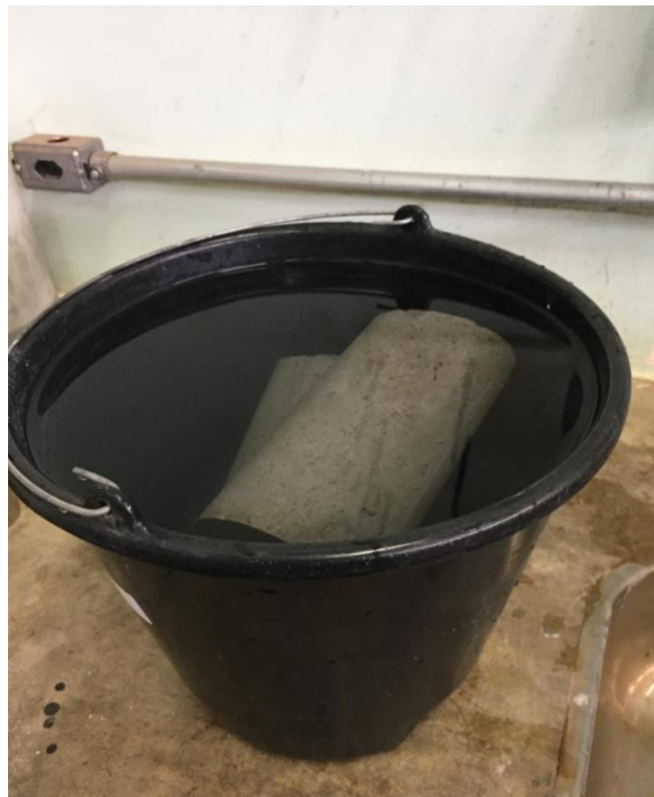
Figura 12 - Corpos de prova submersos por um período de 30 minutos
