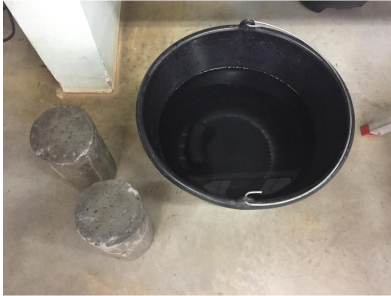
Figura 14 - Corpos de prova e balde com água para simulação do ambiente marinho
