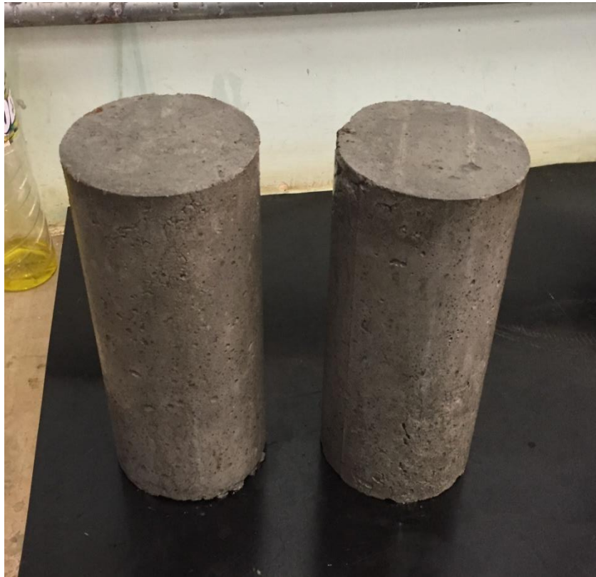
Figura 13 - Corpos de prova secando ao ar livre
