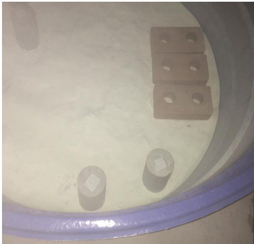
Figura 11 - Corpos de prova submersos em água
