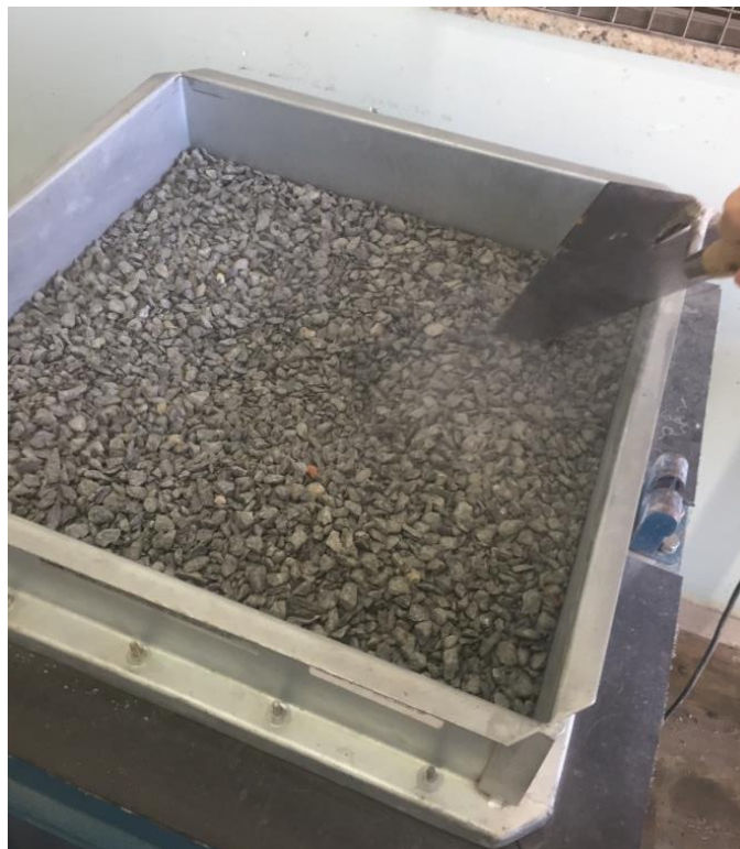
Figura 3 - Peneiramento do agregado graúdo
