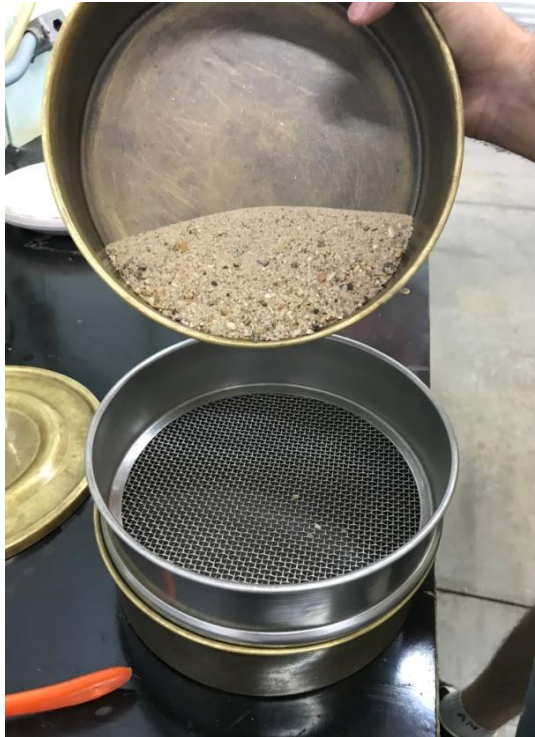
Figura 1 - Caracterização do agregado miúdo
