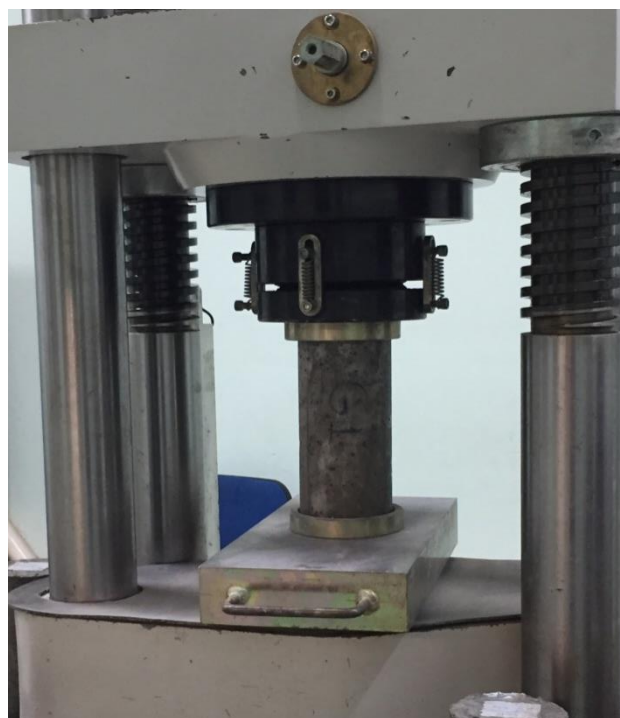
Figura 27 - Ensaio de compressão axial
