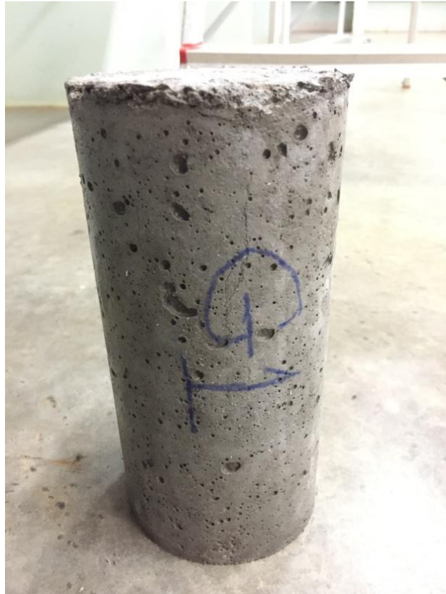
Figura 18 – Corpo de prova sem a presença de patologias
