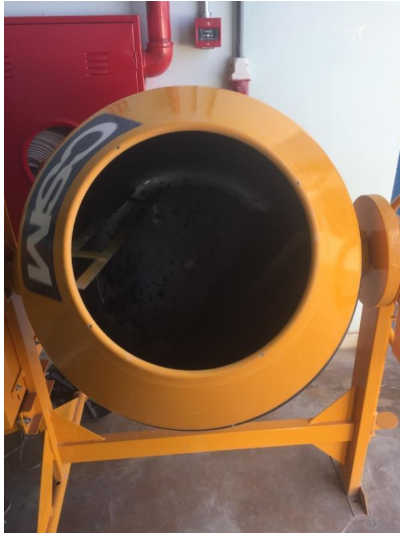
Figura 5 - Mistura do concreto na betoneira
