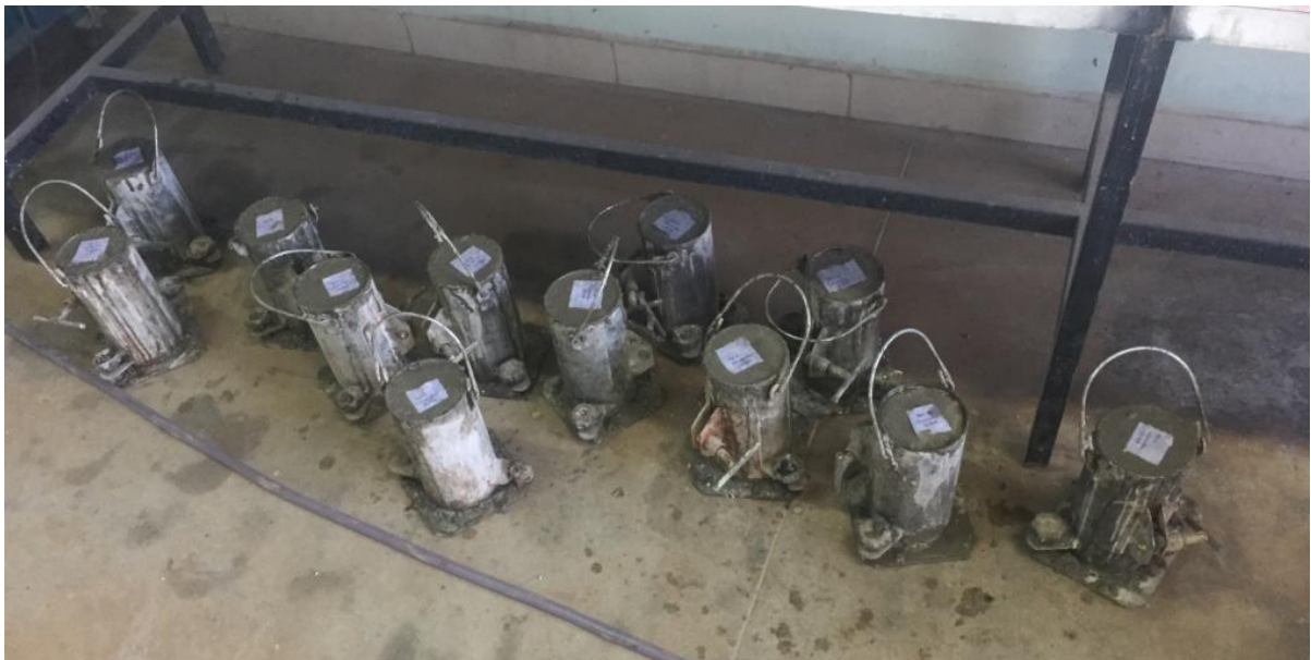
Figura 8 - Corpos de prova moldados e identificados
