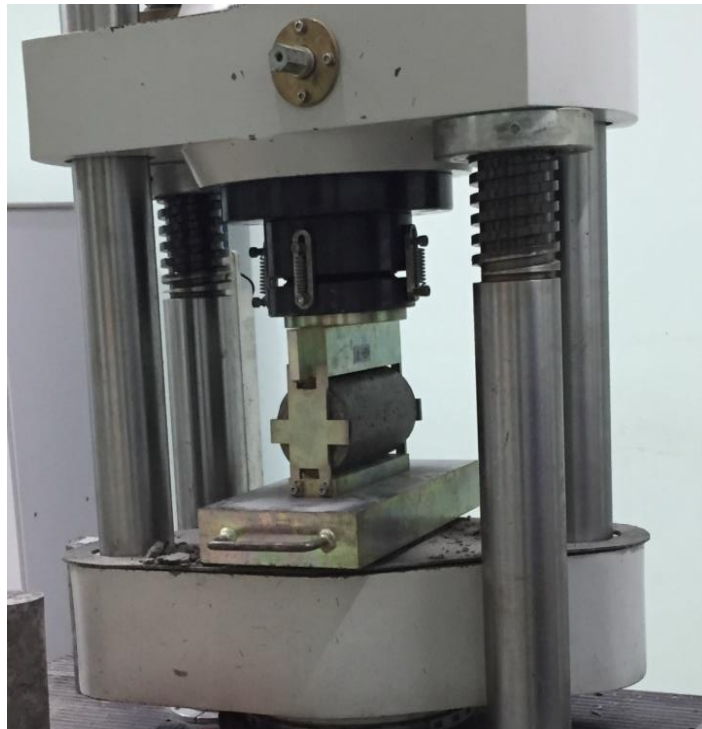
Figura 28 - Ensaio de tração por compressão diametral
