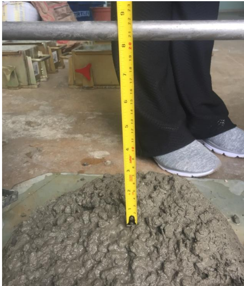
Figura 6 – Slump test do concreto
