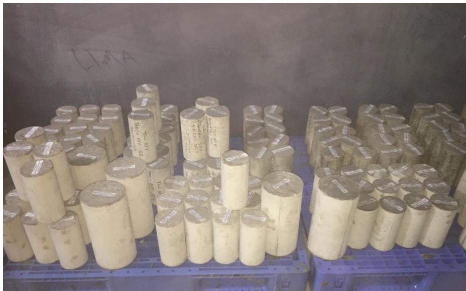
Figura 9 - Cura dos corpos de prova
