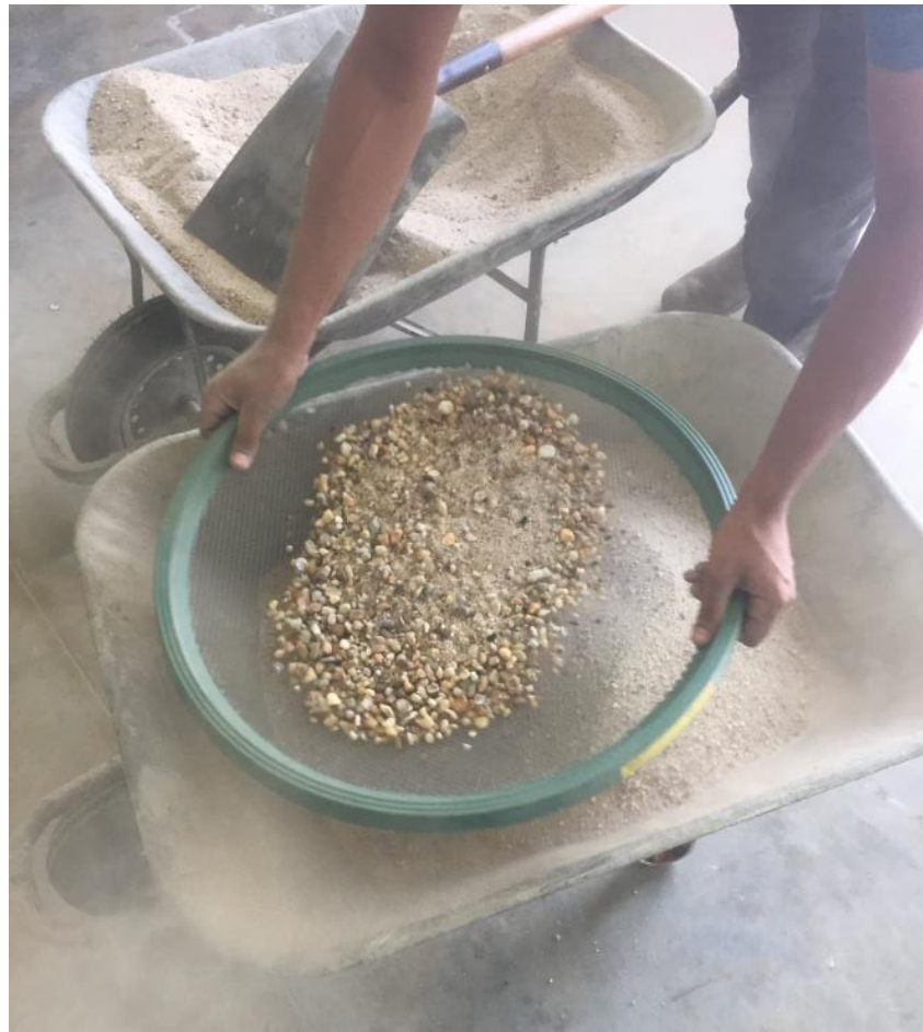
Figura 4 - Peneiramento do agregado miúdo
