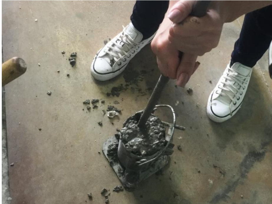
Figura 7 - Moldagem dos corpos de prova
