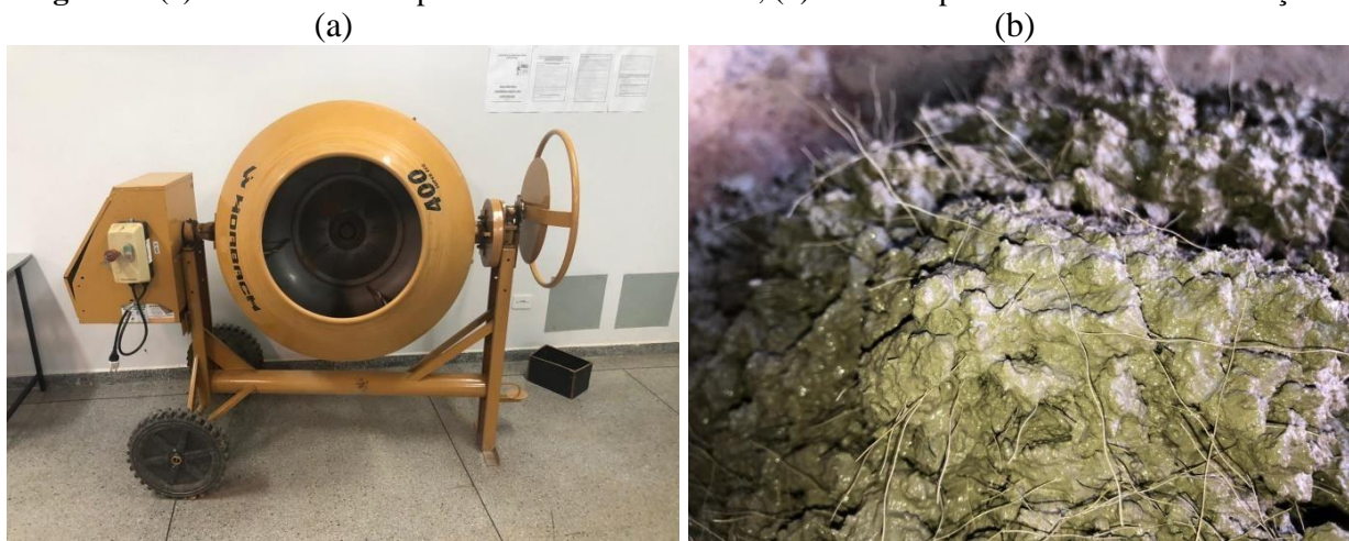
Figura 2. (a) Betoneira usada para mistura dos materiais; (b) concreto produzido com fibras de aço.
