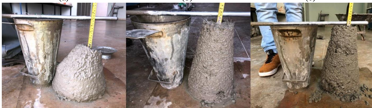
Figura 3. (a) Abatimento traço 0g; (b) Abatimento traço 275g; (c) Abatimento traço 440g.
