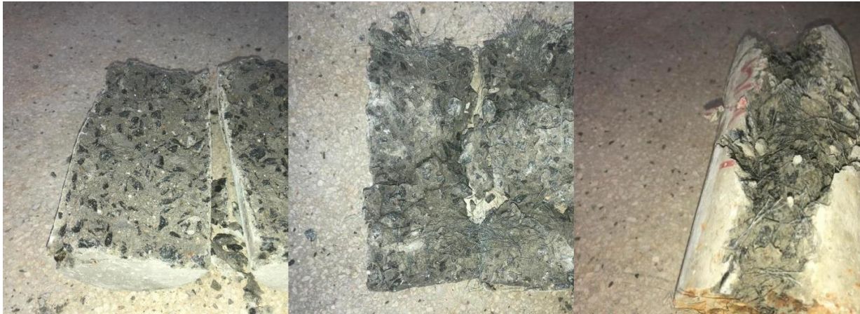
Figura 14. (a) com 0g de fibra; (b) com 275g de fibra; (c) com 440g de fibra.
