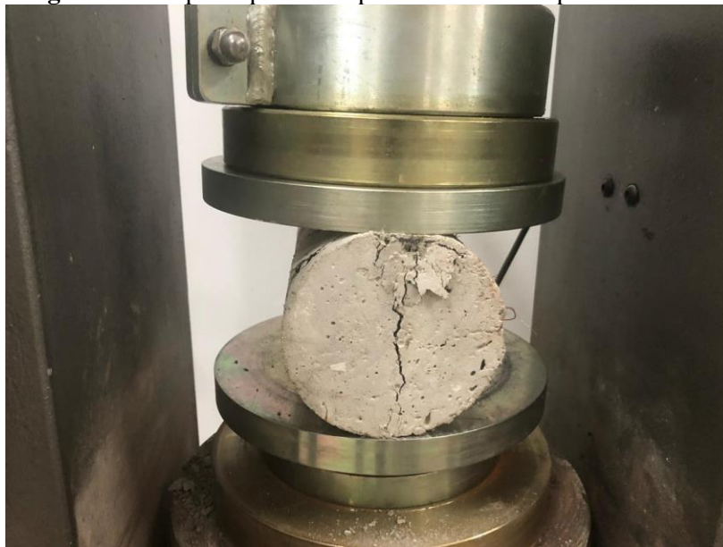
Figura 13. Corpo de prova rompido com o uso de prensa manual.
