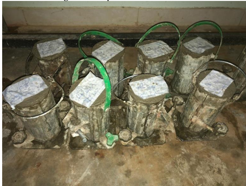
Figura 5. Corpos de prova em cura submersa em solução de água e cal hidratada.
