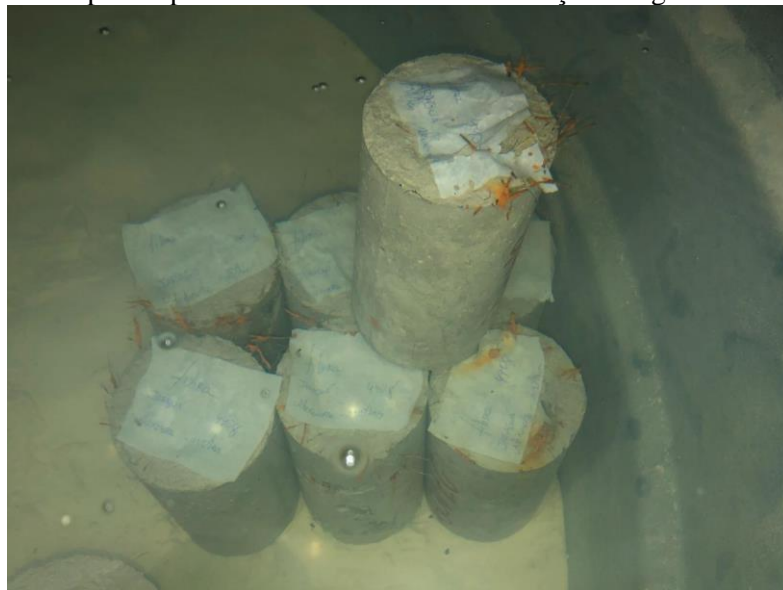
Figura 5. Corpos de prova em cura submersa em solução de água e cal hidratada.
