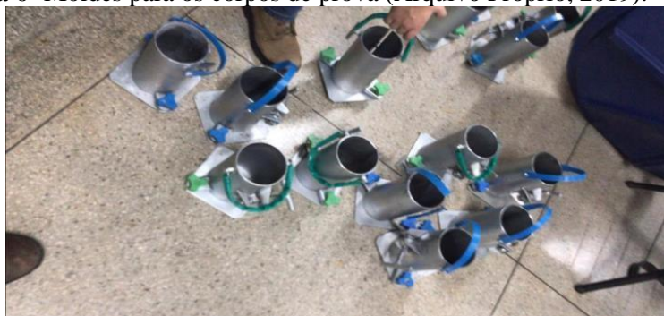
Figura 6- Moldes para os corpos de prova (Arquivo Próprio, 2019).
