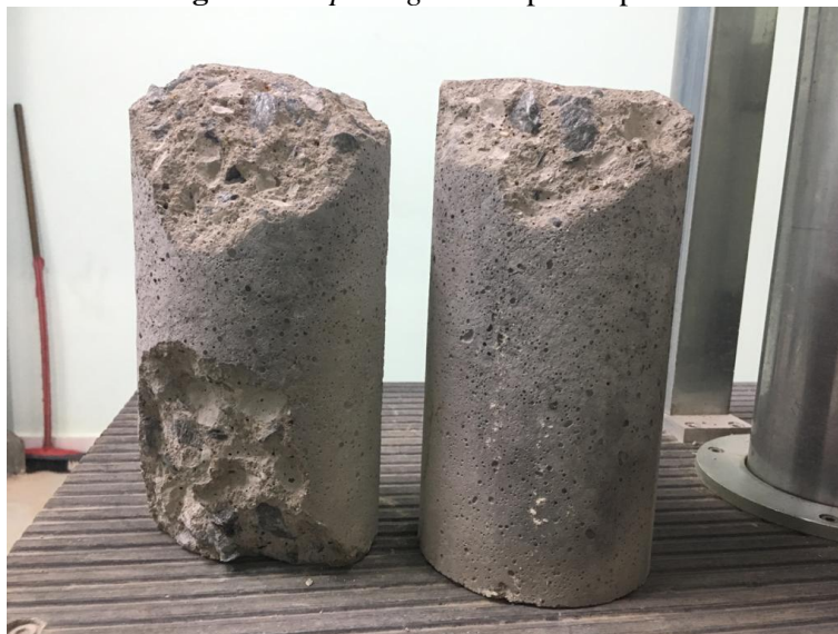
Figura 10. Spalling dos corpos de prova
