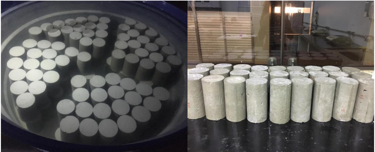
Figura 5. (a) Corpos de prova em cura submersa; (b) Corpos de prova em ambiente de Laboratório.
