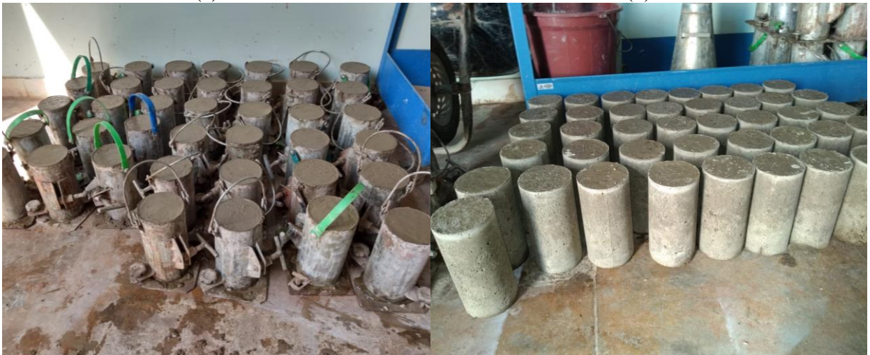
Figura 4. (a) Moldagem dos corpos de prova; (b) Corpos de prova desmoldados.
