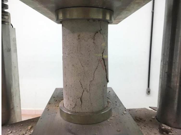
Figura 9. Corpo de prova rompido com o uso de prensa hidráulica.
