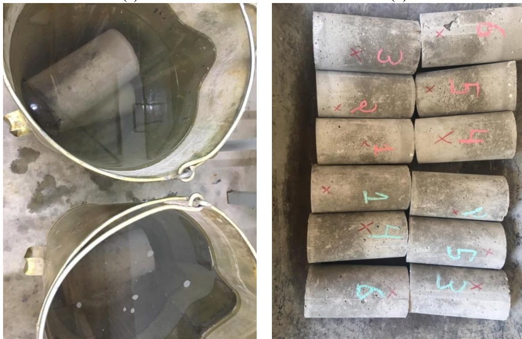
Figura 7. Formas de Resfriamento dos corpos de Prova: a) Brusco e b) Lento.
