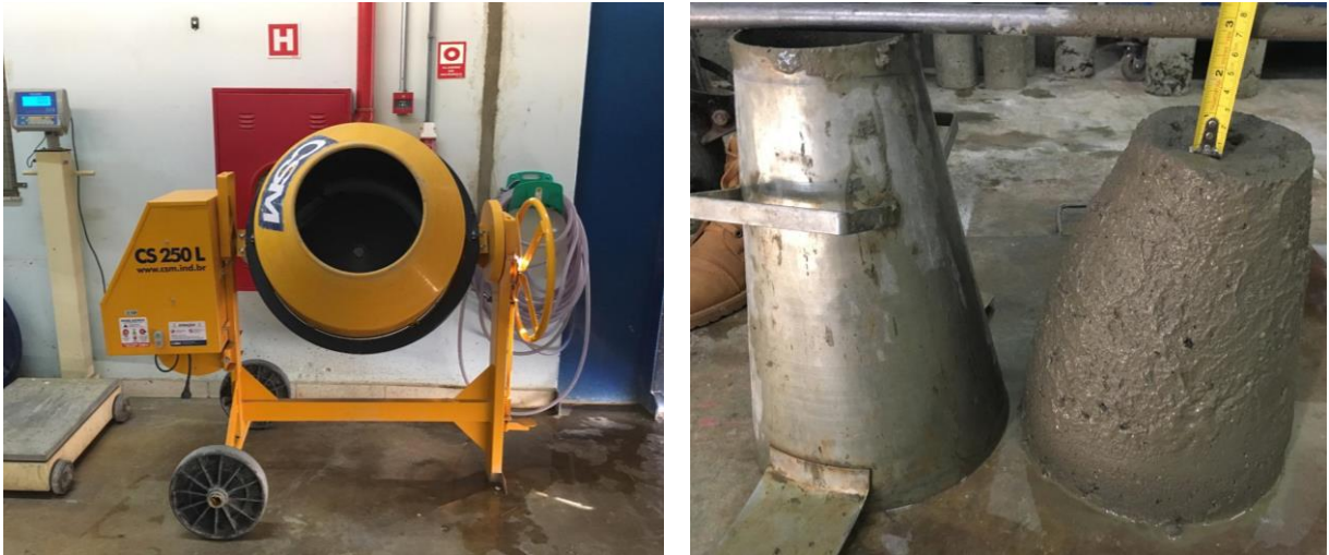
Figura 3. Processo de fabricação do concreto: (a) Betoneira utilizada; (b) Slump Test (Abatimento).
