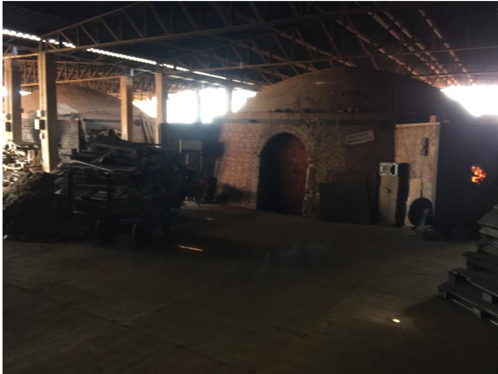
Figura 5: Forno onde os tijolos são queimados da Indústria Cerâmica Menino Jesus 2018 Fonte: Elaborado pelo pesquisador Lucas Ferreira Santos 2018
