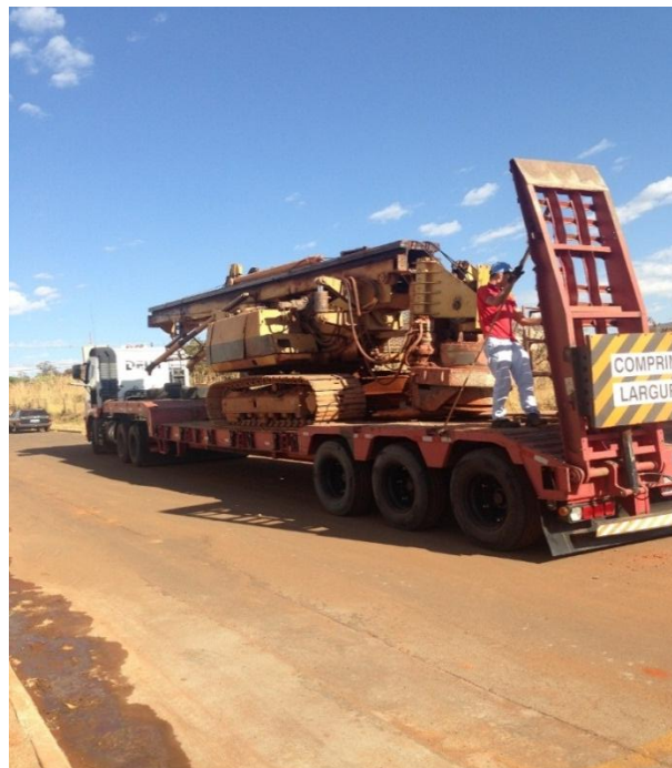
Figura 39: Transporte da máquina perfuradora
