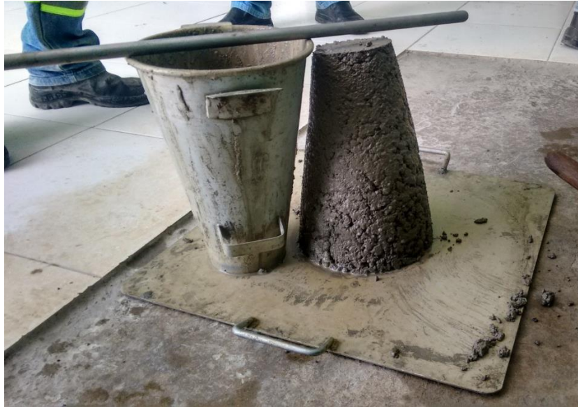
Figura 29 - Ensaio do tronco de cone para determinação do abatimento
