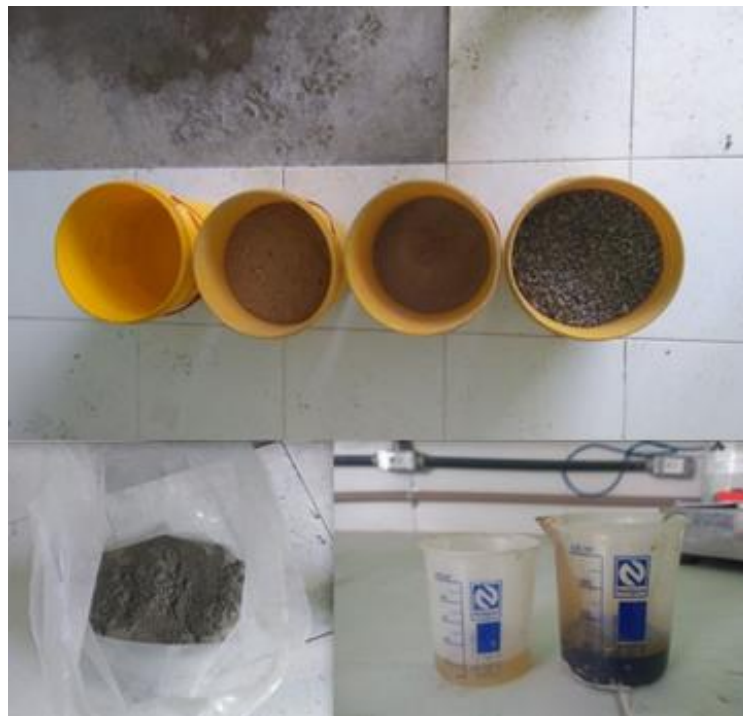
Figura 36 - Materiais pesados para dosagem
