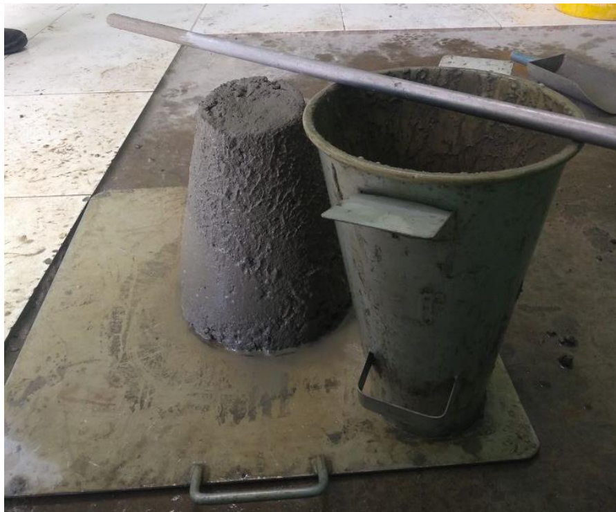
Figura 39 - Ensaio do tronco de cone para determinação do abatimento
