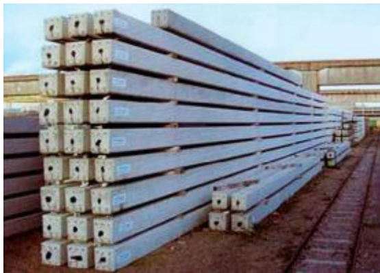
Figura 5 - Pilares de Fundação com CAA
