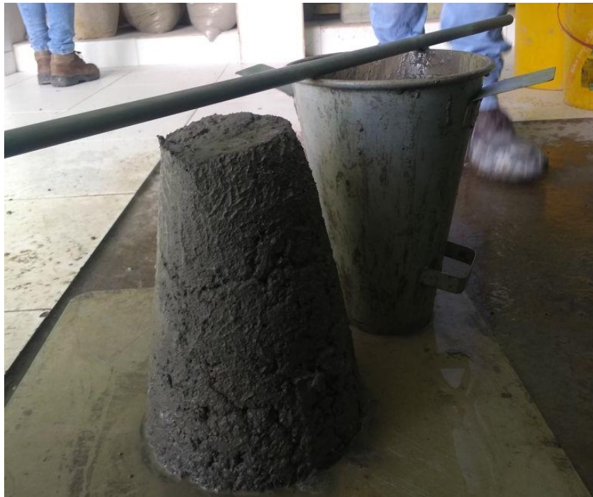
Figura 38 - Ensaio do tronco de cone para determinação do abatimento
