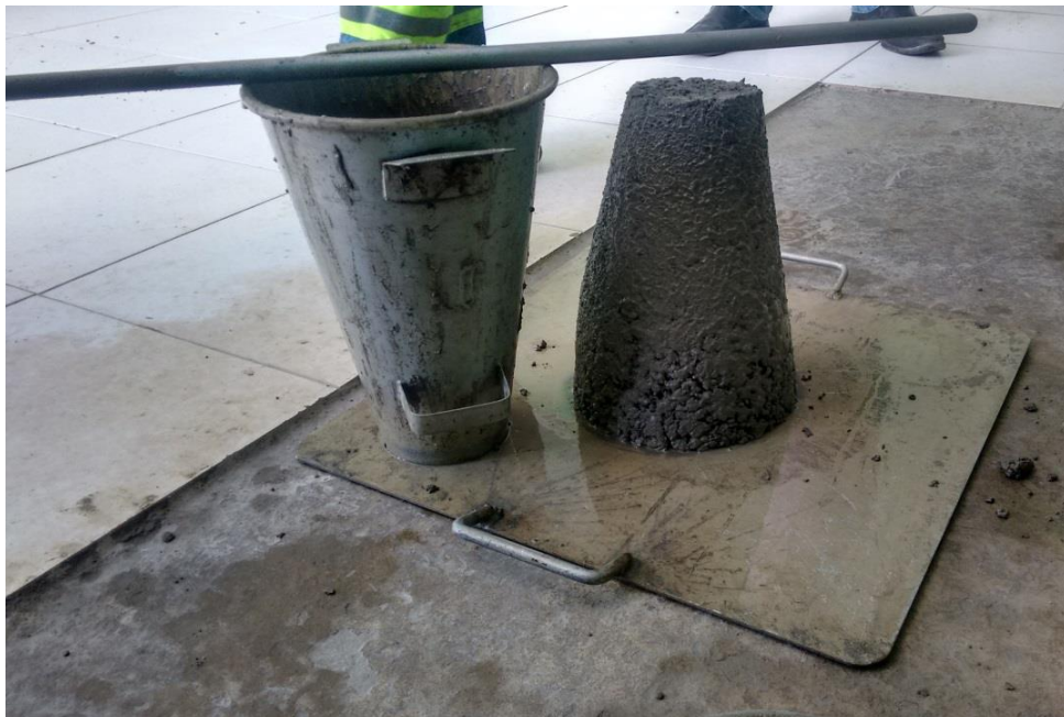
Figura 32 - Ensaio do tronco de cone para determinação do abatimento
