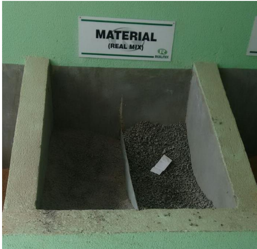
Figura 23 - Armazenamento do pó de pedra e brita
