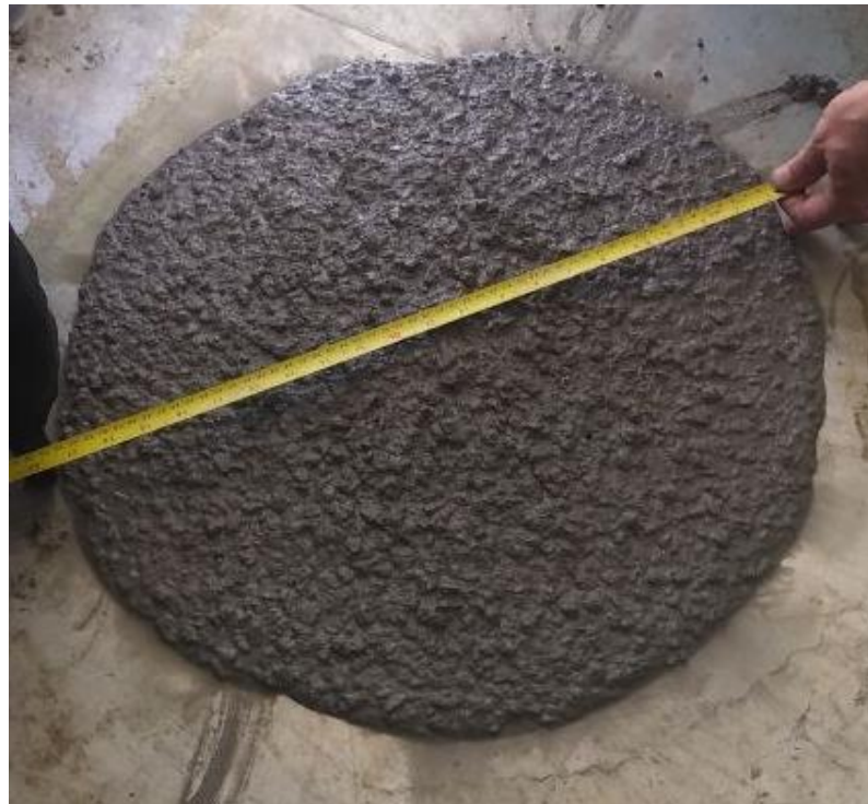
Figura 35 - Ensaio slump flow test da amostra
