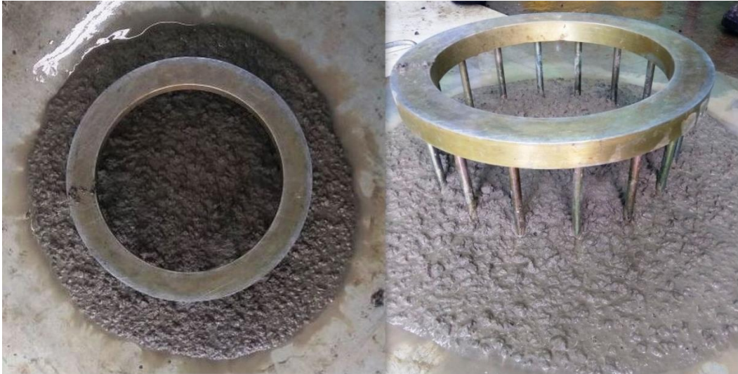
Figura 43 - Ensaio do anel J da amostra
