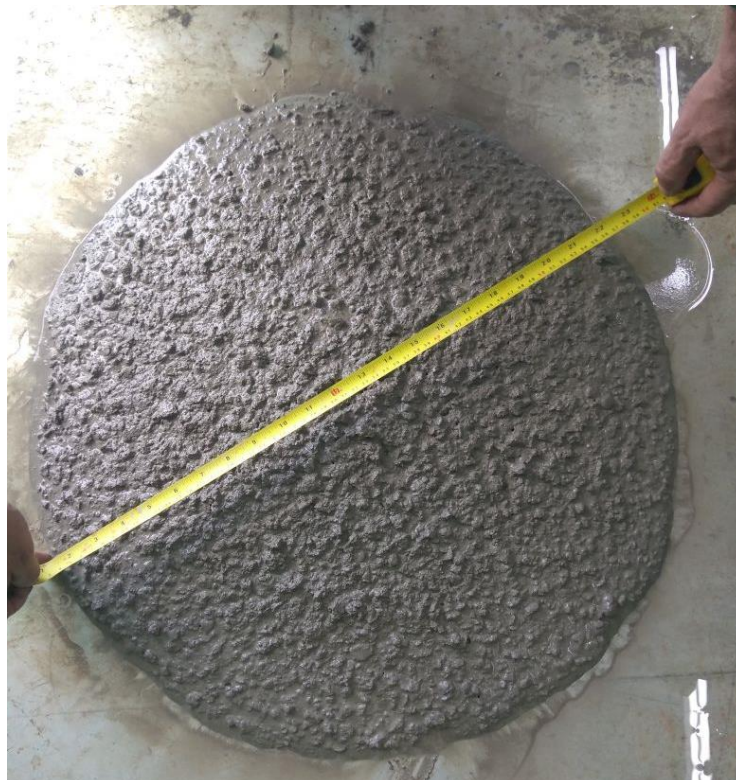
Figura 42 - Ensaio de slump flow test da amostra
