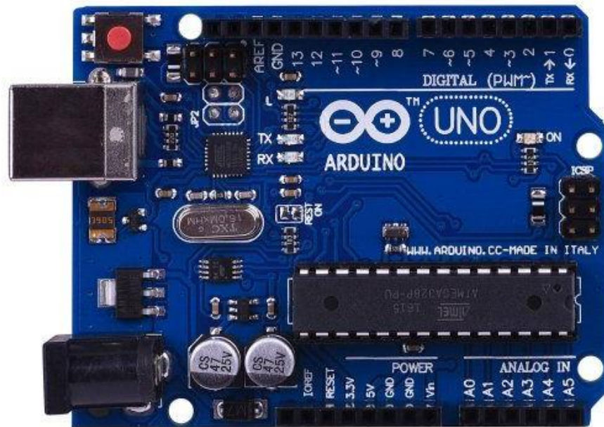
Figura 4.8 - Placa do Microcontrolador Arduino UNO (Fonte: http://Arduino.cc/en/Main/ArduinoUNO )
