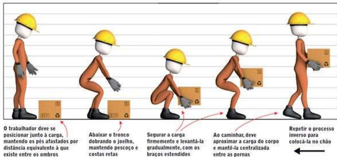
Figura 2.1 - Postura correta para transportar carga manual
