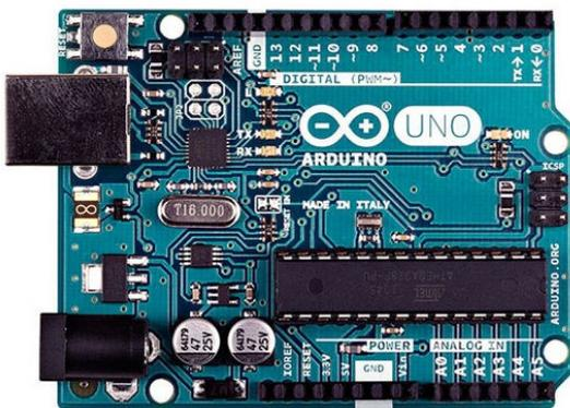
**Figura 10:** Placa Arduino Uno
