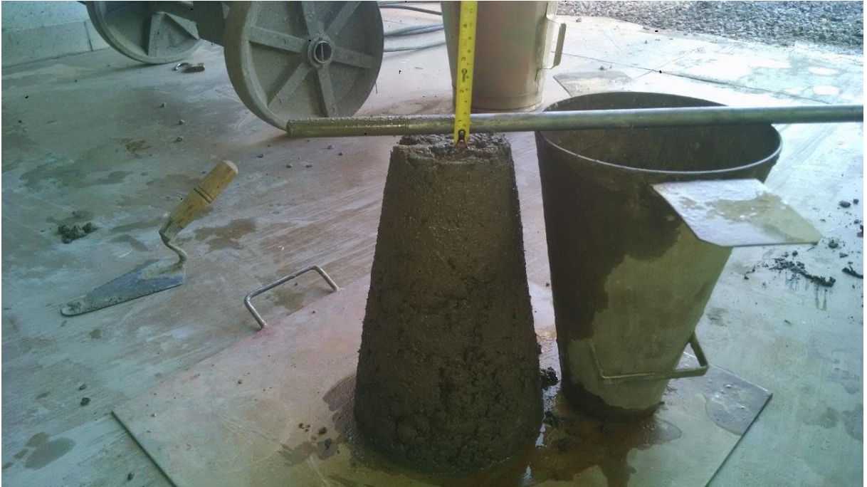
Figura 36 – Ensaio de Abatimento - Borracha média 4%
