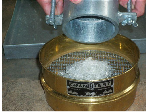
Figura 13 – Ensaio de granulometria do vidro moído
