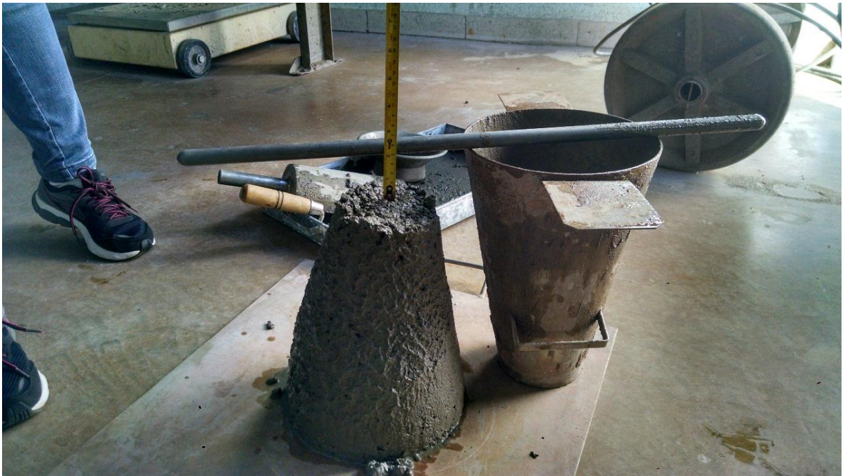
Figura 38 – Ensaio de Abatimento - Borracha fina 4%
