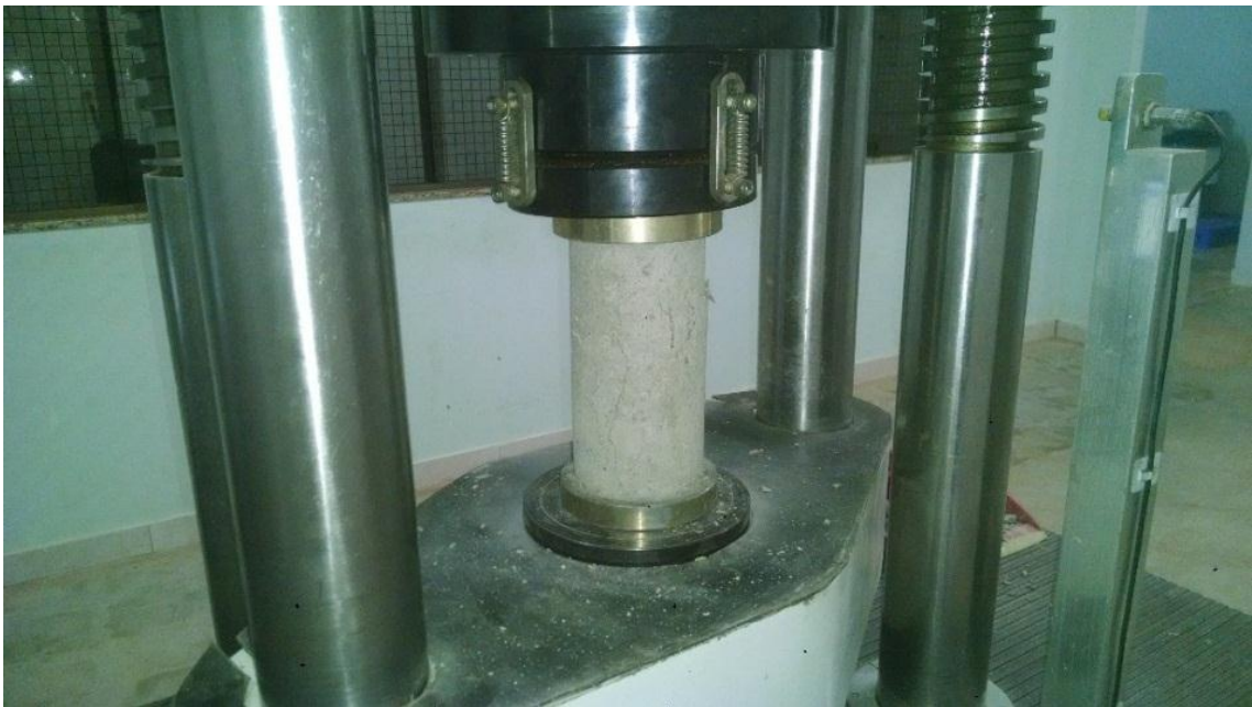
Figura 28 – Corpo de prova rompido aos 28 dias – Borracha média 8%
