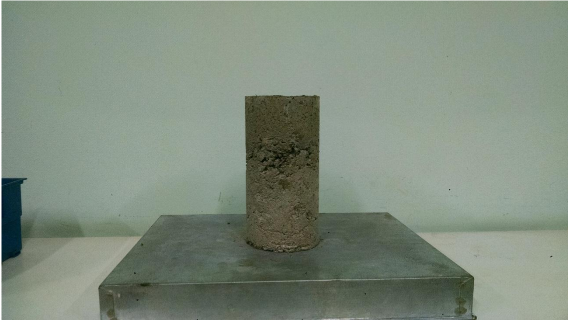
Figura 40 - Falha de adensamento – Amostra 3
