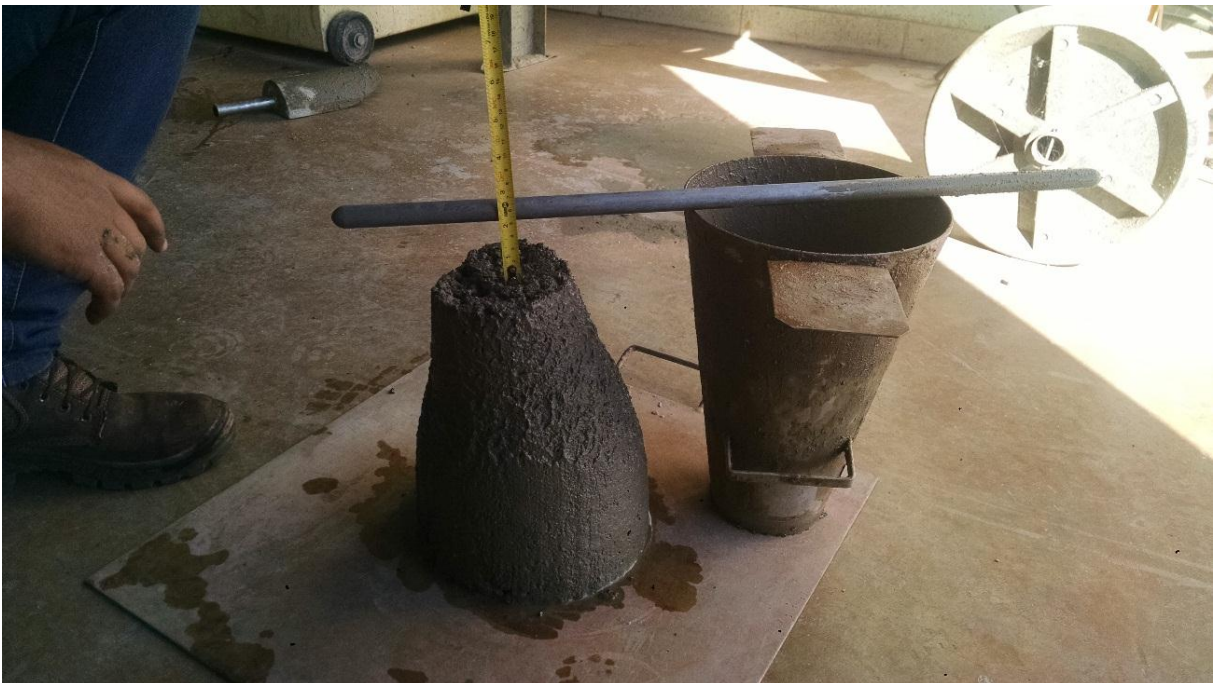
Figura 37 – Ensaio de Abatimento - Borracha fina 8%
