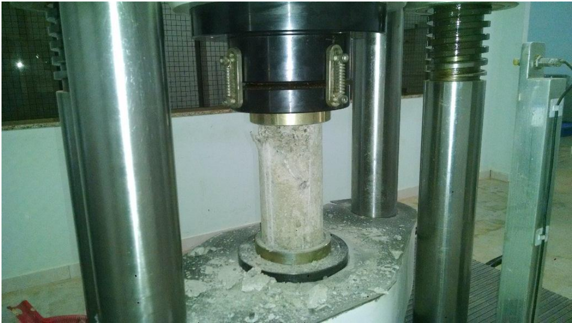
Figura 31– Corpo de prova rompido aos 28 dias – Borracha fina 4%
