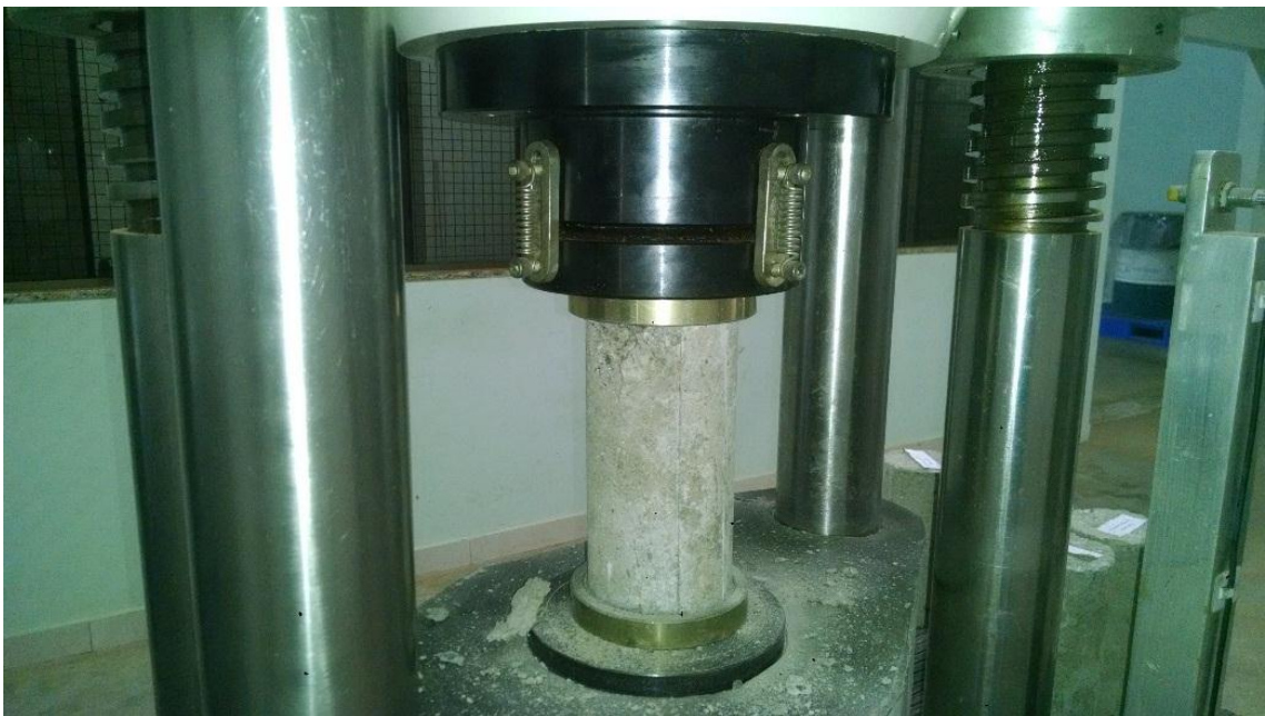
Figura 30 – Corpo de prova rompido aos 28 dias – Borracha fina 8%
