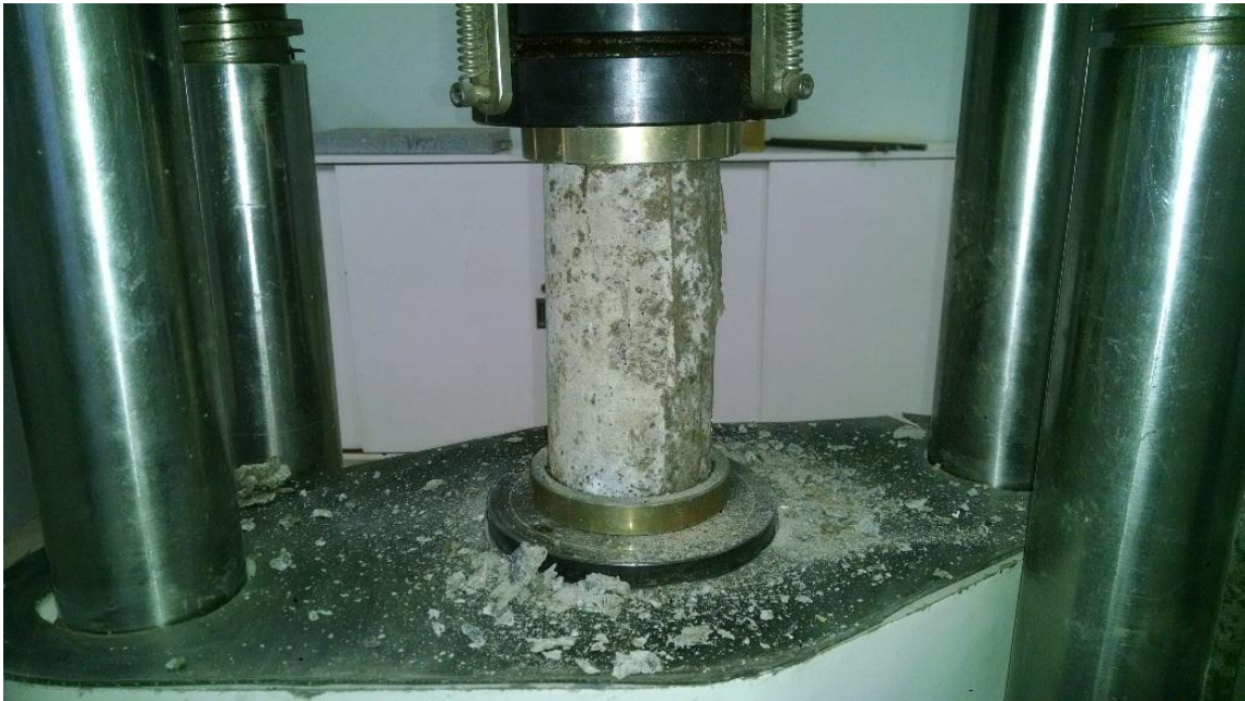
Figura 26 – Corpo de prova rompido aos 28 dias – Borracha total 8%
