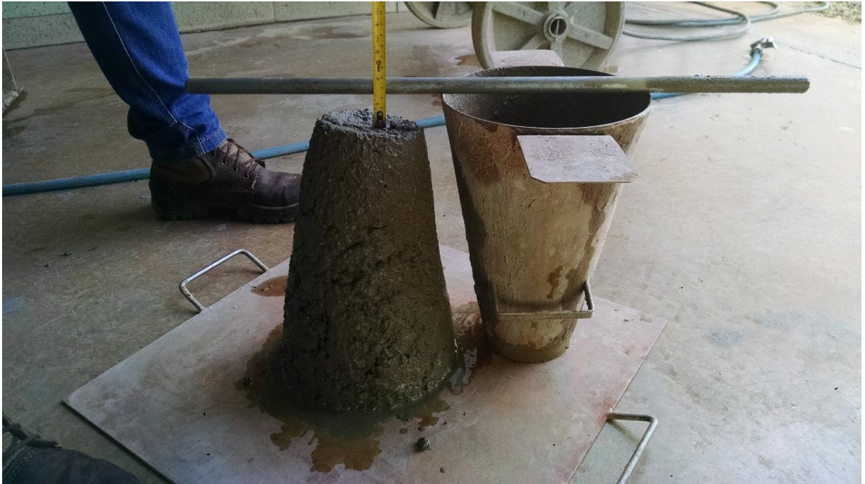
Figura 32 – Ensaio de Abatimento - Traço de referência
