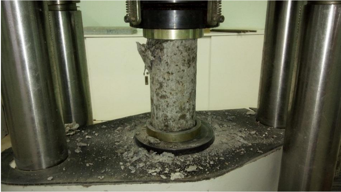
Figura 27 – Corpo de prova rompido aos 28 dias – Borracha total 4%
