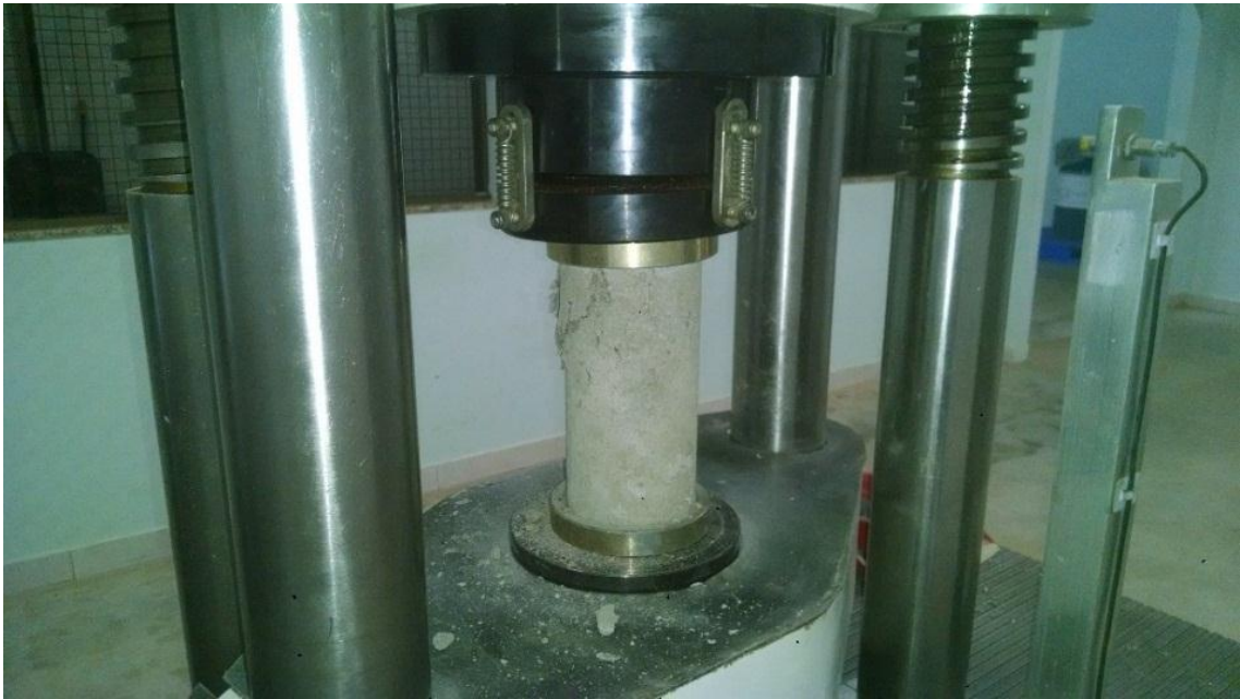
Figura 29 – Corpo de prova rompido aos 28 dias – Borracha média 4%
