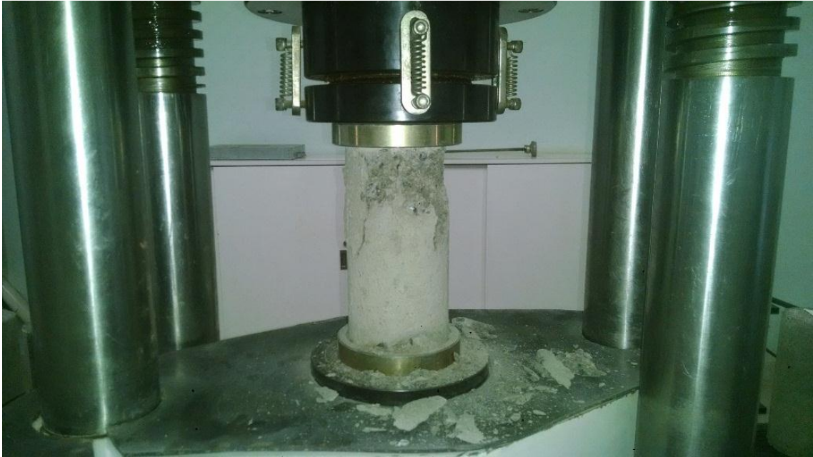
Figura 25 - Corpo de prova rompido aos 28 dias – Traço de referência
