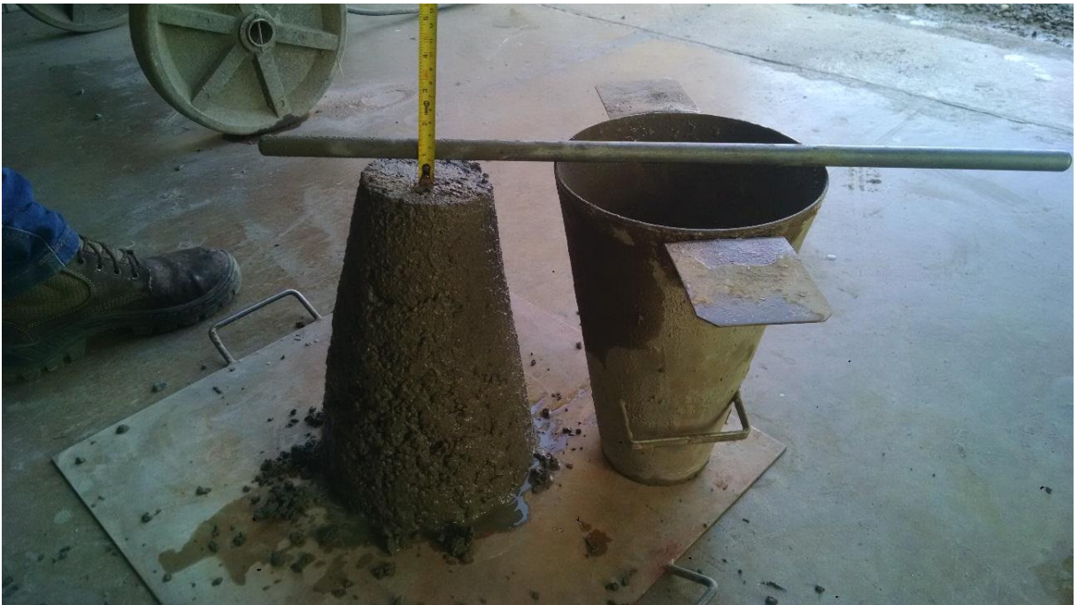
Figura 35 – Ensaio de Abatimento - Borracha média 8%
