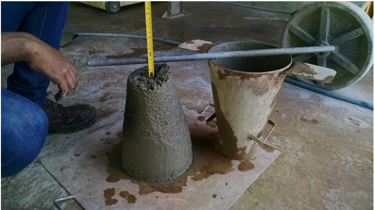
Figura 33 – Ensaio de Abatimento - Borracha total 8%
