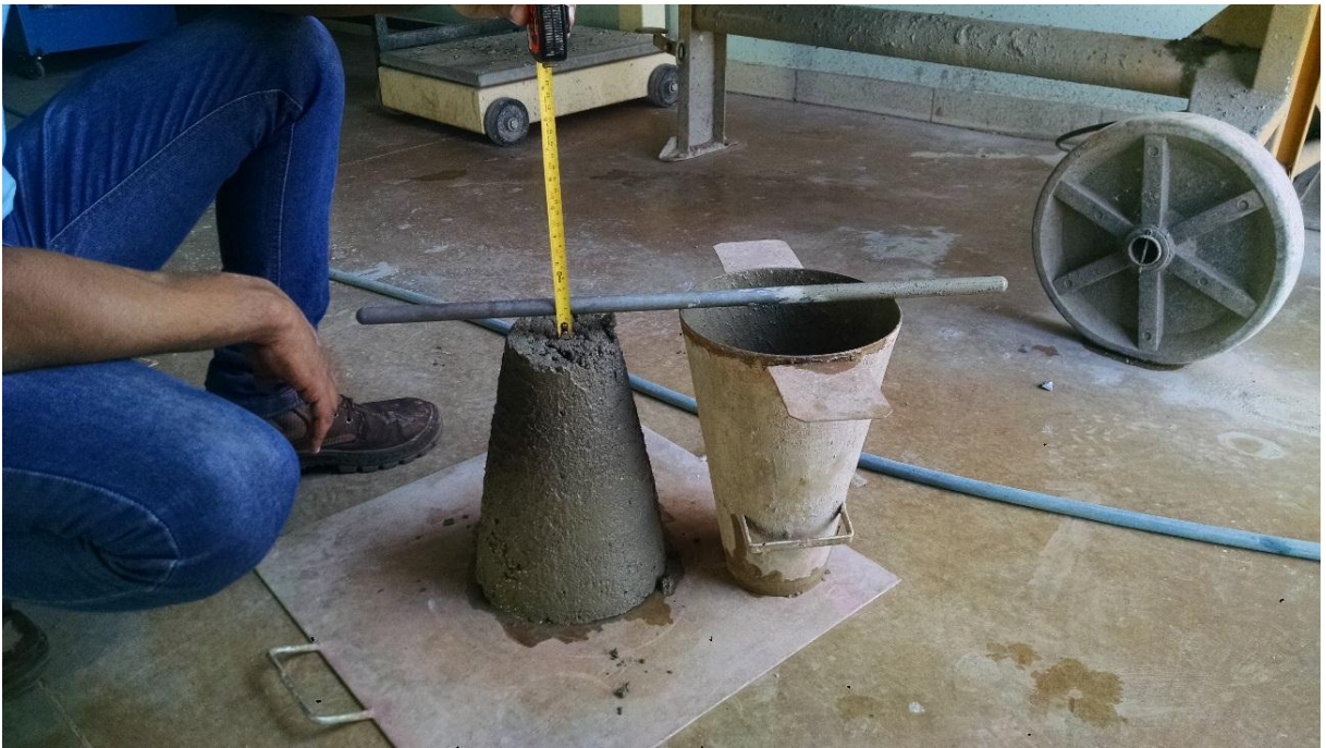
Figura 34 – Ensaio de Abatimento - Borracha total 4%
