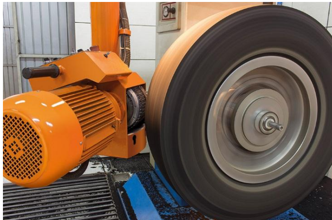
Figura 14 – Raspagem mecânica do pneu
