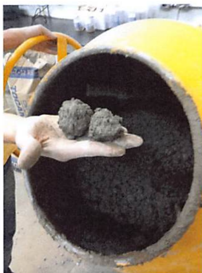
Figura 11 - Concreto com um mal amassamento
