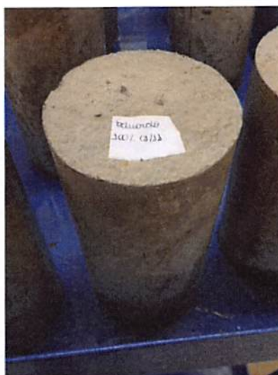
Figura 3.5 – Corpo de Prova 15cm X 30cm
