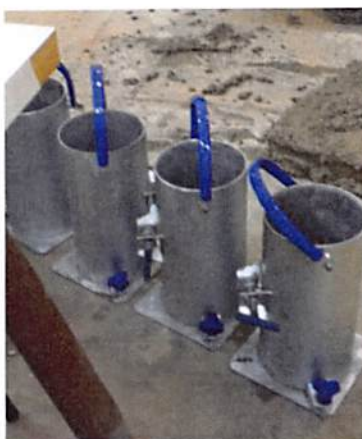
Figura 3.4 – Moldes de corpos de prova
