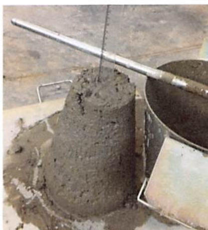
Figura 3.8 – Ensaio do abatimento do tronco de cone
