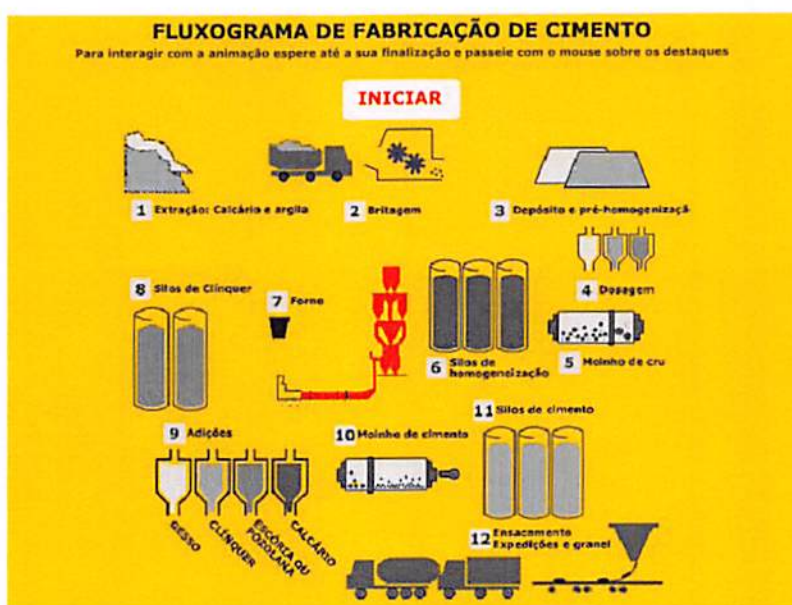
Figura 2.1 – Fluxograma de fabricação de Cimento (FONTE: ABCP)
