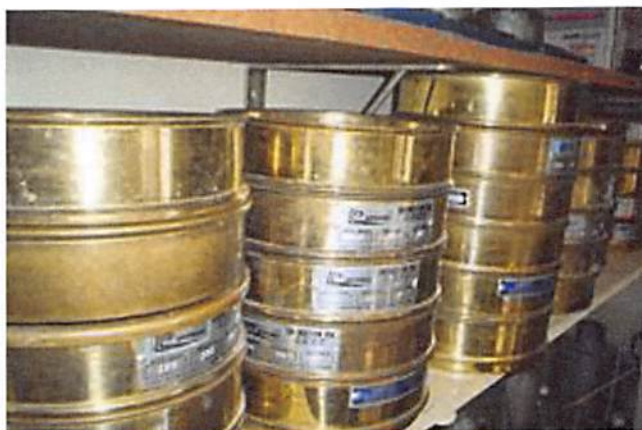
Figura 2.2 – Peneiras Normalizadas pela ABNT (FONTE: Assunção,2009)
