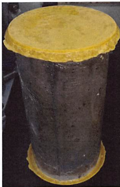
Figura 3.11 – Corpo de prova Capeado
