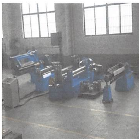
Fig. 5.3: Máquinas de corte ( sliter )
