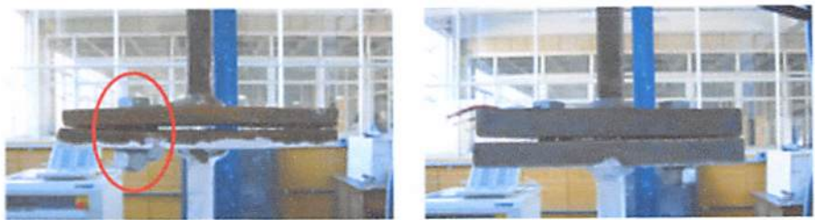
Fig. 3.20 - Colapso por tração, com efeito, alavanca nos parafusos. Fonte: IME-2010.
