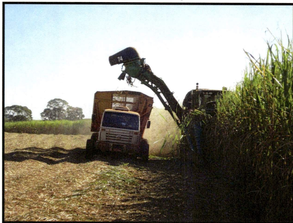
Figura 2 - Colhedora fazendo o carregamento da cana picada no transbordo.
