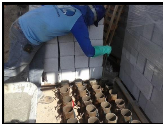
Figura 12 - Corpos de prova para ensaio em Laboratório
