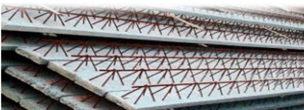
Figura 8 – Estrutura de uma viga treliçada
