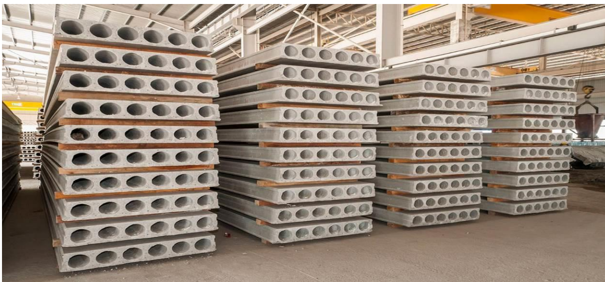
Figura 7 – Laje de concreto protendido
