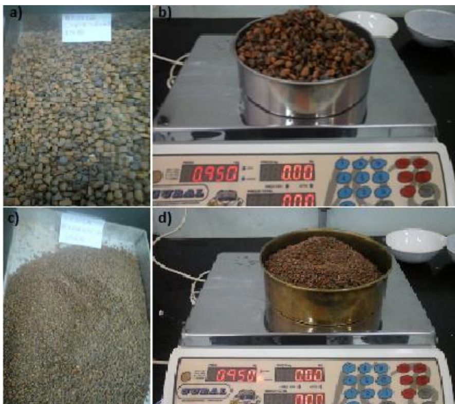
Figura 12 – a) Argila 1506 b) Dosagem da argila 1506 para a preparação dos concretos c) Argila 0500. d) Dosagem da argila 0500 para a preparação dos concretos
