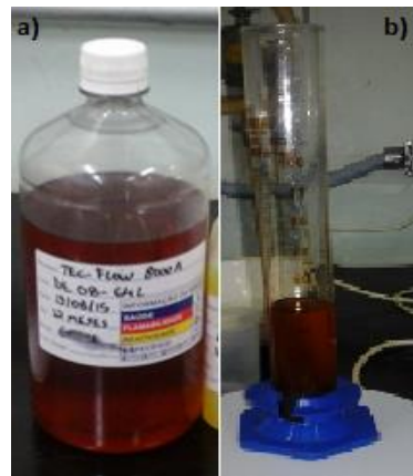
Figura 13 – a) Aditivo utilizado Tec Flow-8000 A. b) Dosagem do aditivo para a preparação dos concretos
