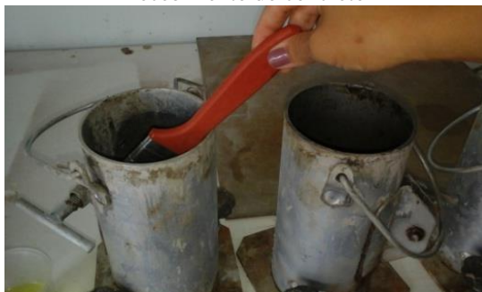
Figura 20 - Preparação com desmoldante para o recebimento do concreto
