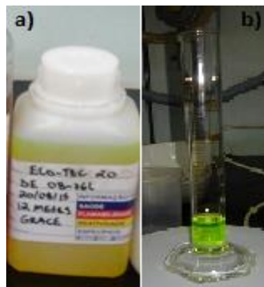
Figura 14 – a) Aditivo utilizado Eco Tec 20. b) Dosagem do aditivo para a preparação dos concretos.
