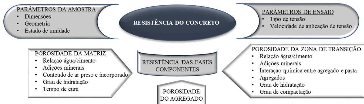
Figura 8 - Fatores influentes na definição da resistência à compressão do concreto
