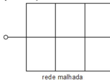
Figura 2 – Tipos de traçados das redes de distribuição de água.
