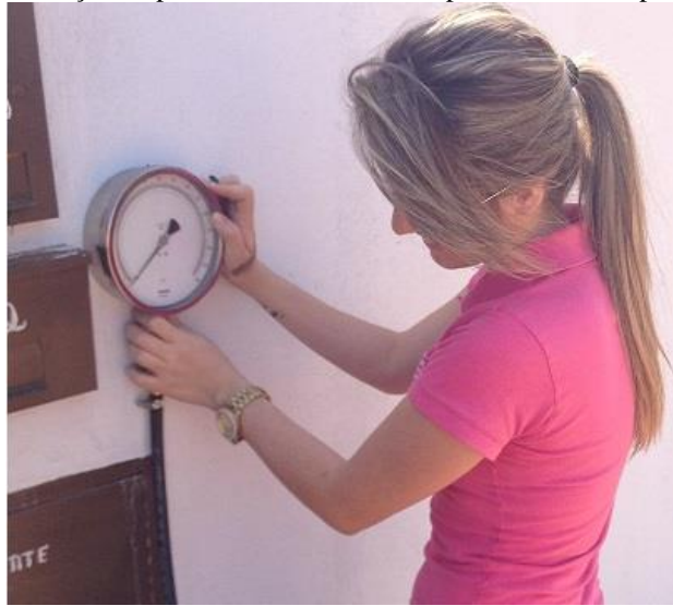
Figura 15 – Aferição da pressão em determinado ponto do Município de Silvânia
