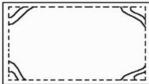
Figura 4 – Fissuração por deficiência de armaduras
