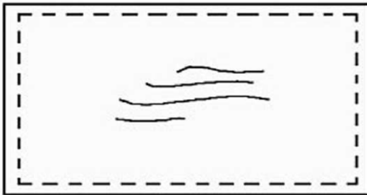
Figura 3 – Fissura por esmagamento do concreto
