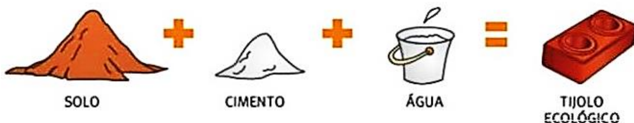
Figura 3: Processo fabricação Solo-cimento
