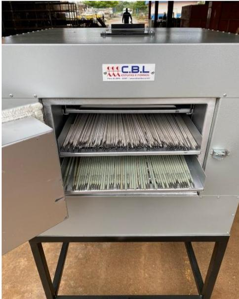
(a) Forno com eletrodos
