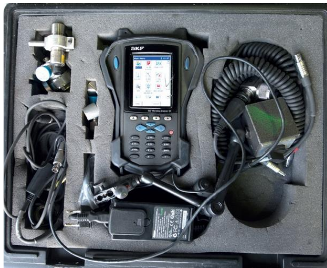
Figura 9 - SKF Microlog CMXA 70 com Acessórios
