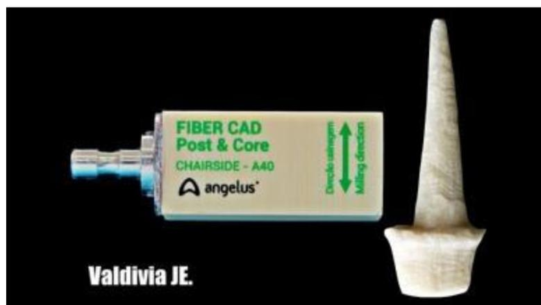
**Figura 02.** Bloco de fibra de vidro para usinagem (à esqu.) do retentor intraradicular customizado (à dir. ). Retentor projetado e usinado pela tecnologia CAD-CAM. Fonte <https://www.youtube.com/watch?v=Waed-5aHfhQ>
