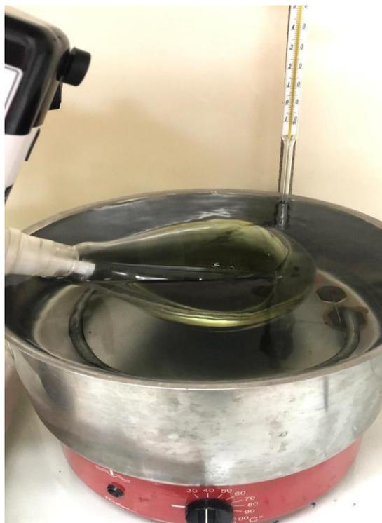
**Figura 04.** Secagem da amostra em rotaevaporador.
