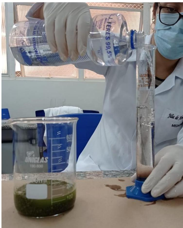
**Figura 02.** Maceração da amostra pulverizada com álcool.
