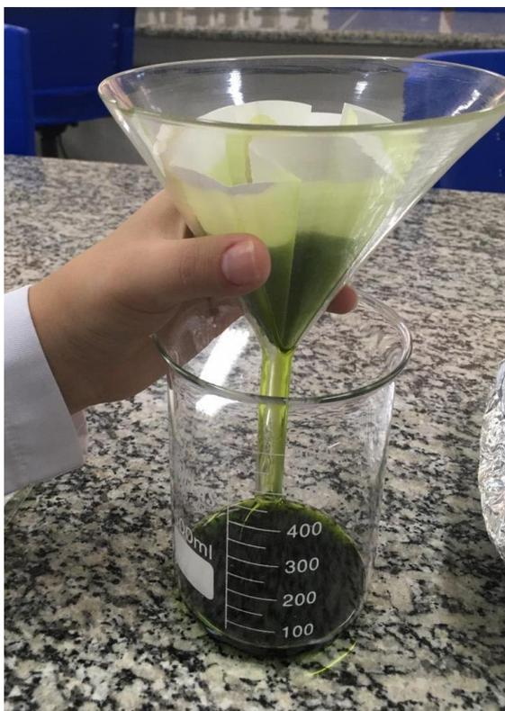
**Figura 03.** Filtração do extrato obtido.
