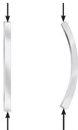
Figura 11 – flambagem em peça esbelta
