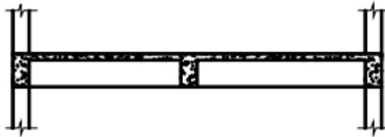
Figura 6 – Laje maciça em concreto armado
